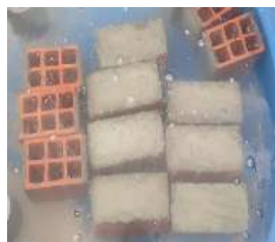
Figura: 28 - Blocos capeados imersos em água. Fonte: Autor (2022).
