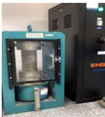
Figura 7: Prensa hidráulica utilizada nos ensaios de resistência à compressão simples.
