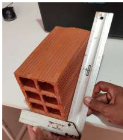
Figura 23 - medição da planeza das faces de um dos blocos. Fonte: Autor (2023).
