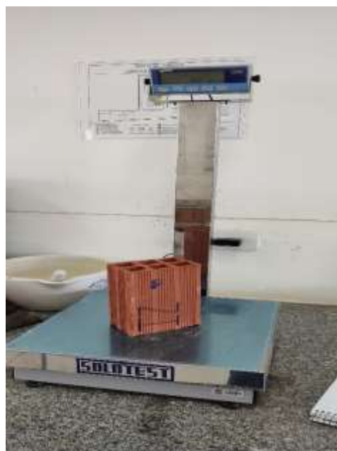
Figura 25 - Pesagem dos blocos. Fonte: o autor (2022).
