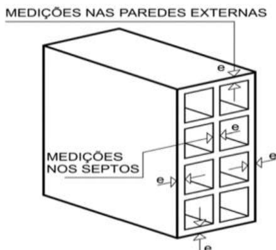
Figura 17 - posições para realização das medições dos septos e paredes externas.
