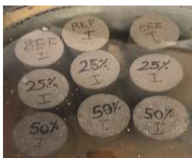
Figura 6: ensaio de moldagem e cura do corpo de prova.
