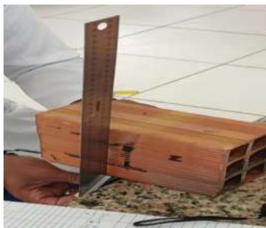
Figura 21 - medição do desvio em relação ao esquadro.
