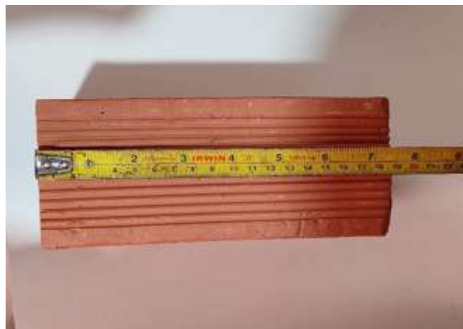
Figura 16 - medição do comprimento do bloco cerâmico.
