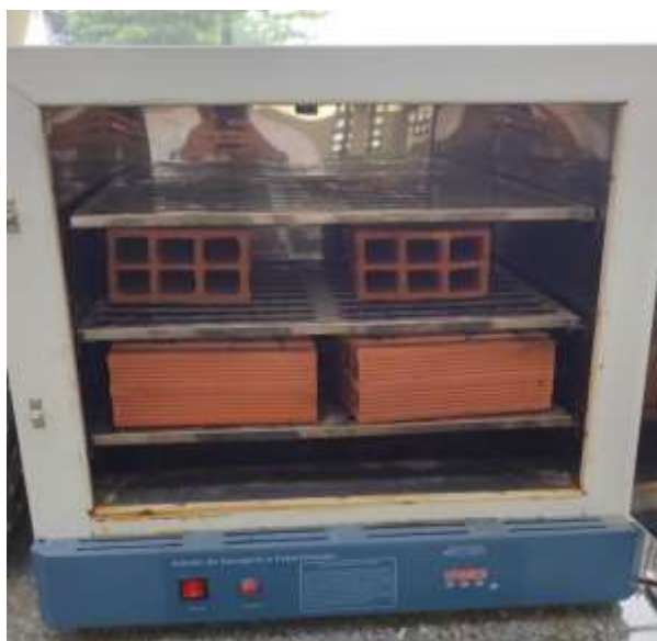
Figura 24 - Blocos cerâmicos na estufa para secagem. Fonte: o autor (2022).
