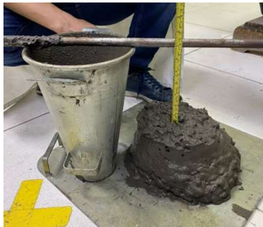
Figura 4: ensaio para avaliação da consistência do concreto (Slump test).
