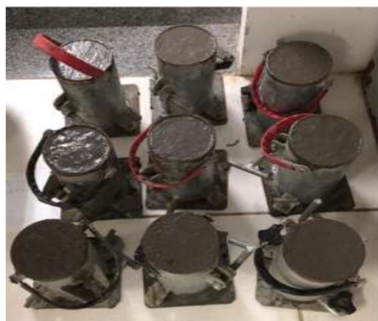
Figura 5: ensaio de moldagem e cura dos corpos de prova.
