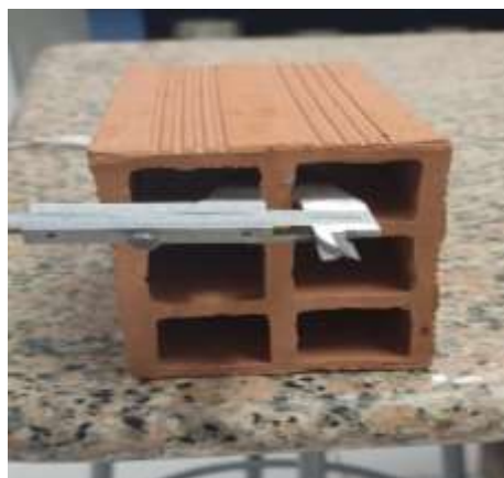
Figura 19 - medição do septo de um dos blocos.
