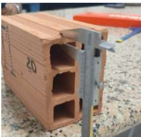
Figura 18 - medição das paredes externas de um dos blocos.
