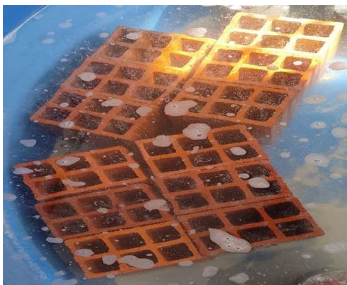
Figura 26 - Blocos submersos em água.
