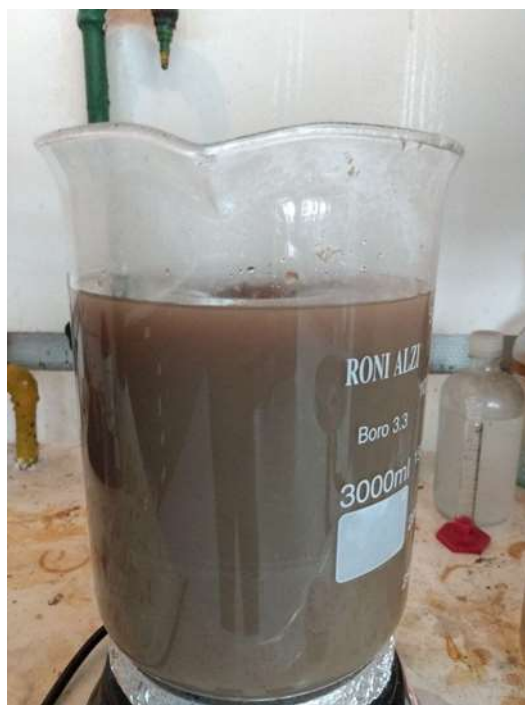
Figura 3 - Reação do resíduo de cobalto com hidróxido de sódio em aquecimento
