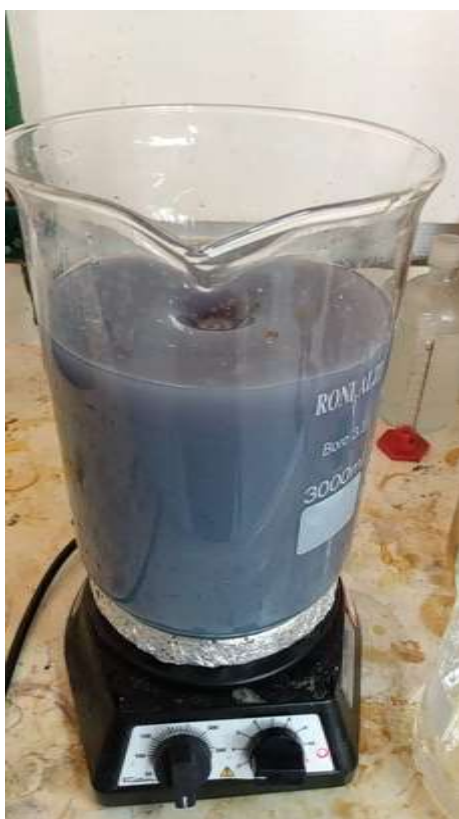
Figura 2 - Reação do resíduo de cobalto com hidróxido de sódio e hidróxido de potássio sem aquecimento.
