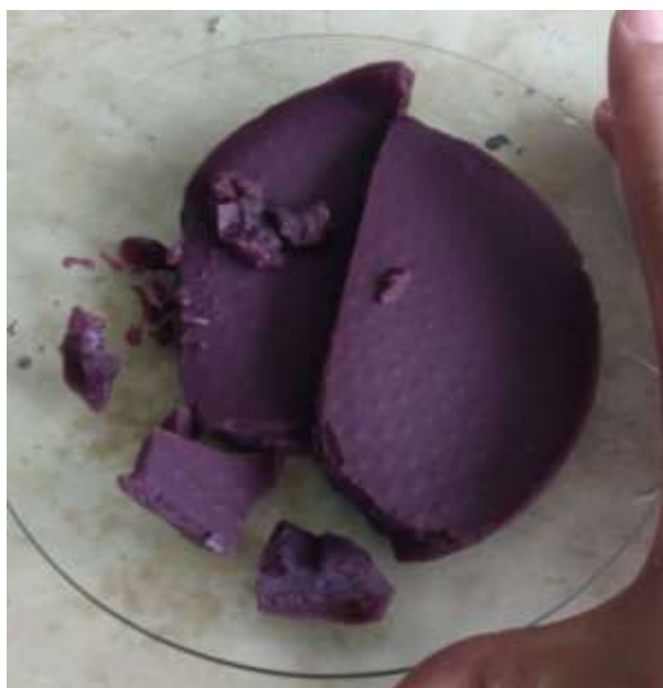
Figura 5 - Sólido roxo obtido na reação do \text{Na}_2\text{CO}_3 e livre de \text{SO}_4^{2-}
