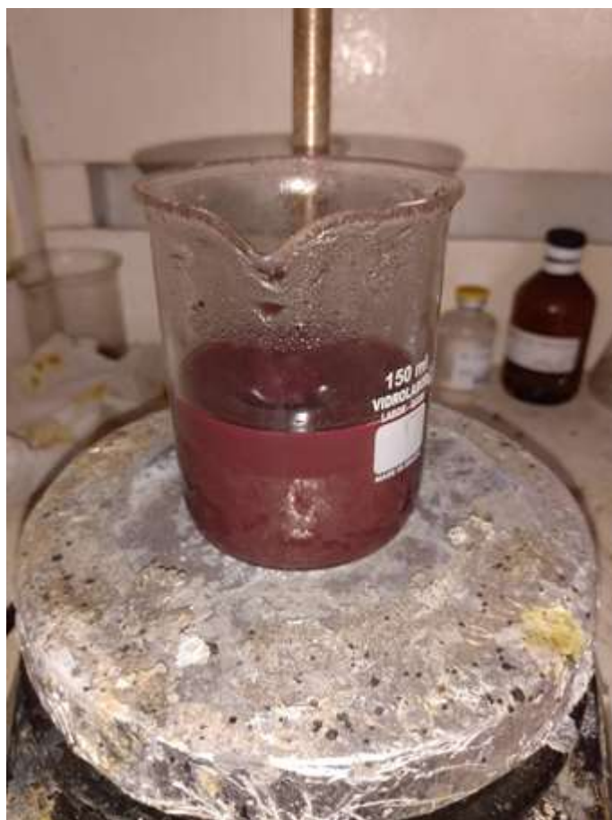
Figura 4 - Mistura de cor vermelha obtida da reação do sólido preto com \text{H}_2\text{SO}_4 50% e \text{H}_2\text{O}_2 30% em agitação e aquecimento
