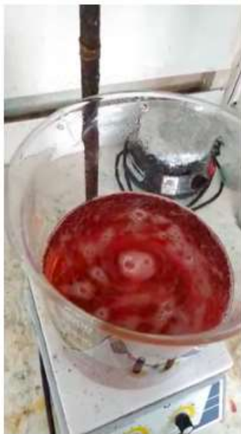
Figura 6 - Solução vermelha de cobalto com valor de pH 1.
