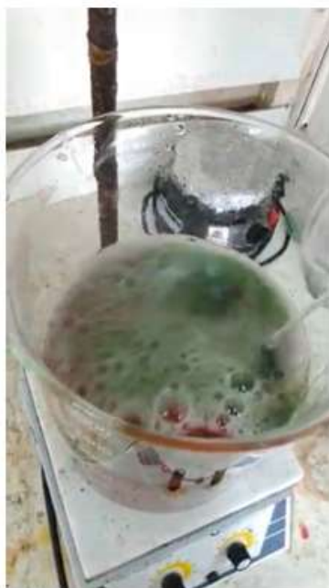
Figura 7 - Formação da coloração verde com a adição de solução de \text{Na}_2\text{CO}_3
