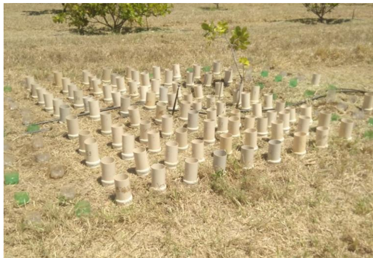
Figura 02. Malha quadrada para coleta da precipitação no microaspersor base
