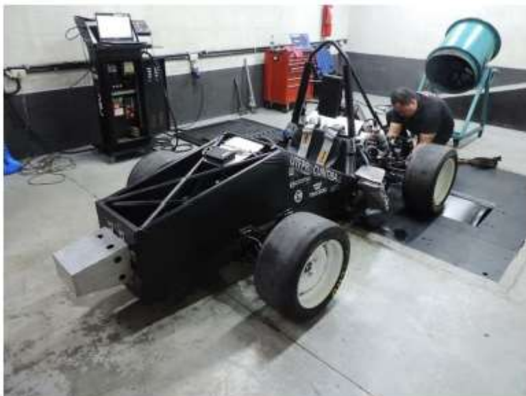
Figura 4 - Fixação do protótipo no dinamômetro. Fonte: Os autores.
