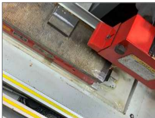
Figura 2 – Processo de retificação plana da amostra de aço 80T.
