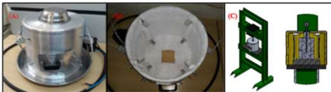
Figura 4: Forno para os ensaios de DPS a morno. (A) Vista externa do equipamento, (B) Detalhes internos e (C) Vista e seção do aparato da montagem da matriz de ECAP como forno de lâmpadas.
