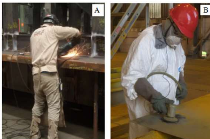
Figura 7: 3ª e 4ª lixadeiras analisadas no estudo de caso. Lixadeira de 7 polegadas (A) e lixadeira do tipo alta frequência (B).
