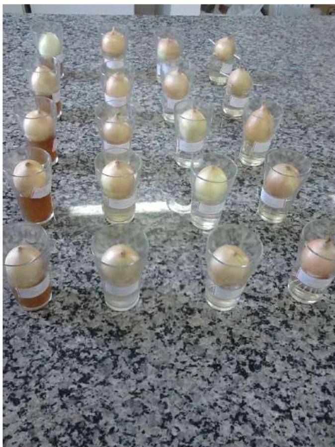
**Figura 1:** Montagem dos ensaios. Da esquerda para direita: efluente bruto, efluente pós coagulação/floculação, controle positivo, efluente pós P.O.A. O controle positivo foi feito por coleta de raízes anteriormente a exposição aos tratamentos.
