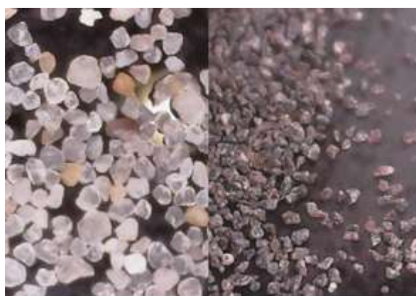
Figura 2 - Agregados retidos na peneira #80 utilizados no estudo
