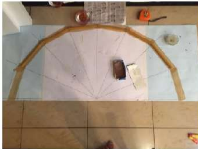
Figura 6 – Formação do arco.
