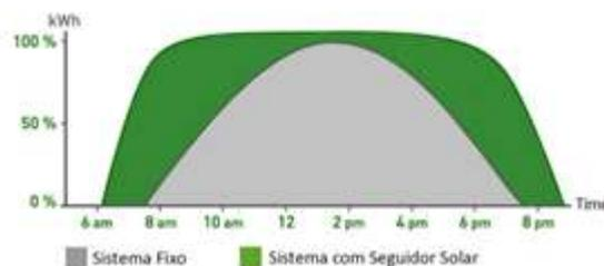
Figura 3: Diferença da energia gerada: sistemas fixos vs. seguidor solar.
