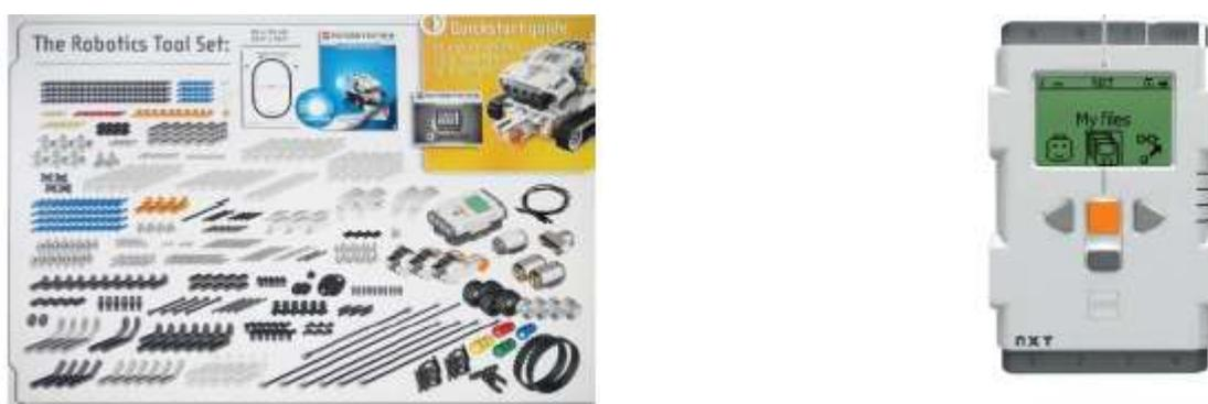
Ele também possui um módulo controlador de programação intuitiva (Smart Brick) mostrado na figura 1(b) que é o “cérebro” do robô consistindo de 1 conexão para cabo USB, 4 entradas para sensores e 3 saídas para servo-motores. A comunicação é feita via cabo USB ou bluetooth com computadores ou celulares. A alimentação do bloco programável NXT é feita por seis pilhas AA 1,5V comuns, pilhas recarregáveis de 1,2 V.
