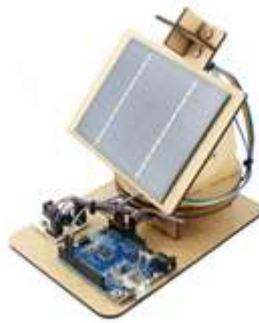
Figura 5: Rastreador Solar com Arduino e Sensor LDR.
