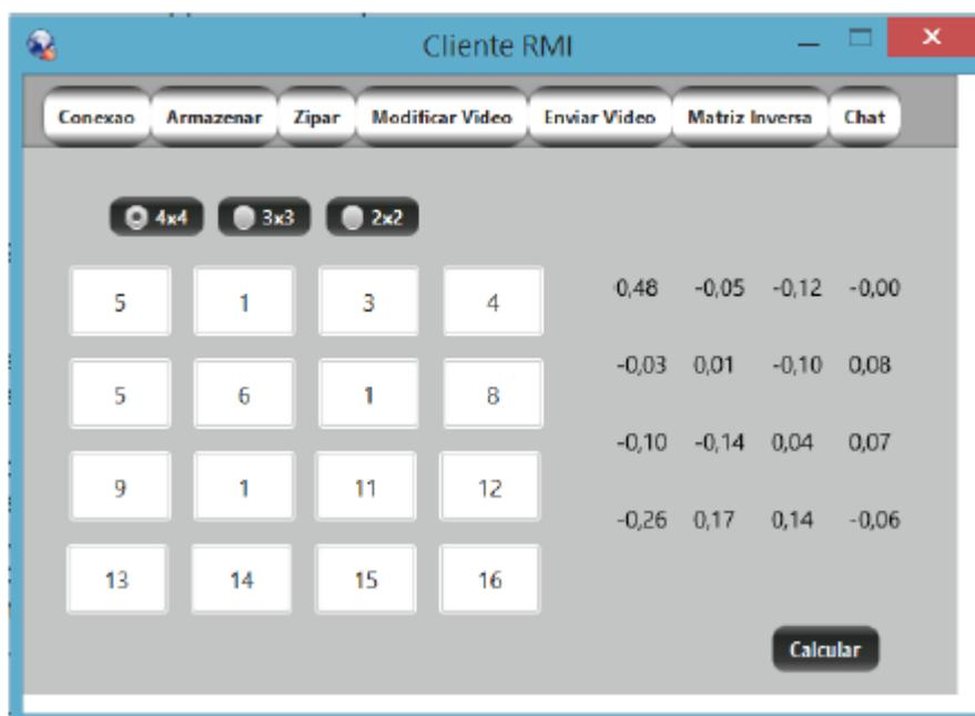
Figura 7 – Interface gráfica do cliente executando o método da matriz inversa
