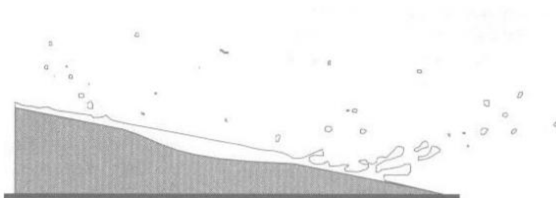
Figura 5: Exemplo de salpicamento ocasionado pela Erosão Hídrica
