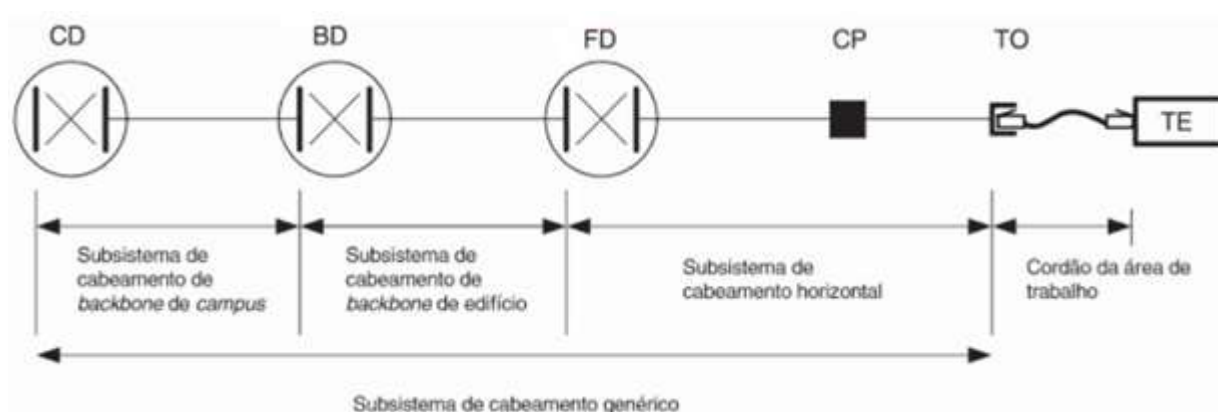
Figura 5 – Subsistema de cabeamento genérico
