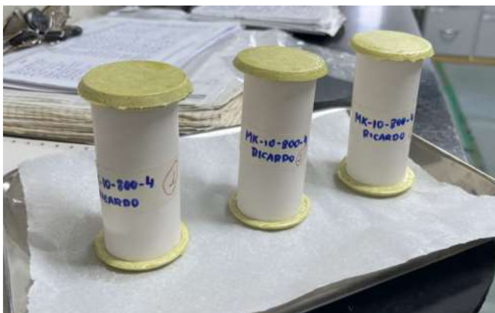
Figura 5: Corpos de prova cilíndricos capeados com enxofre.
