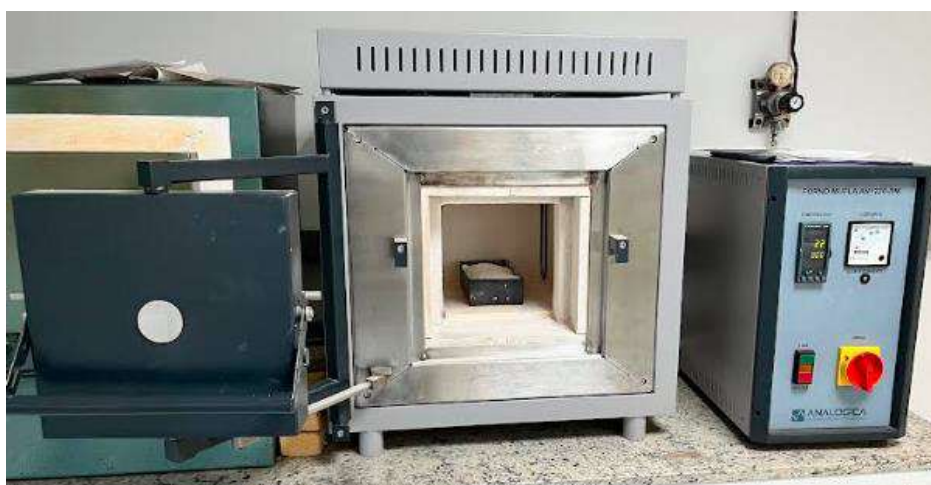
Figura 4: Mufla utilizada na calcinação.
