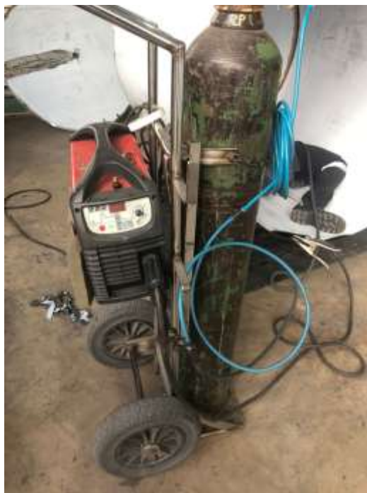
Figura 28 - Solda do tipo TIG, realizada em campo
