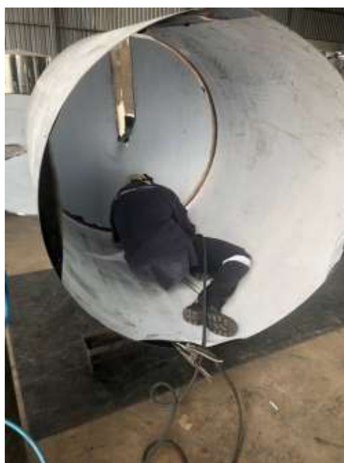
Figura 28 - Solda do tipo TIG, realizada em campo
