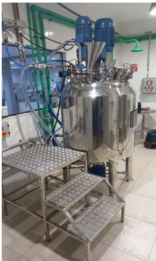
Figura 44 - Foto em Campo Tanque IRL-TT-500 INOX 316
