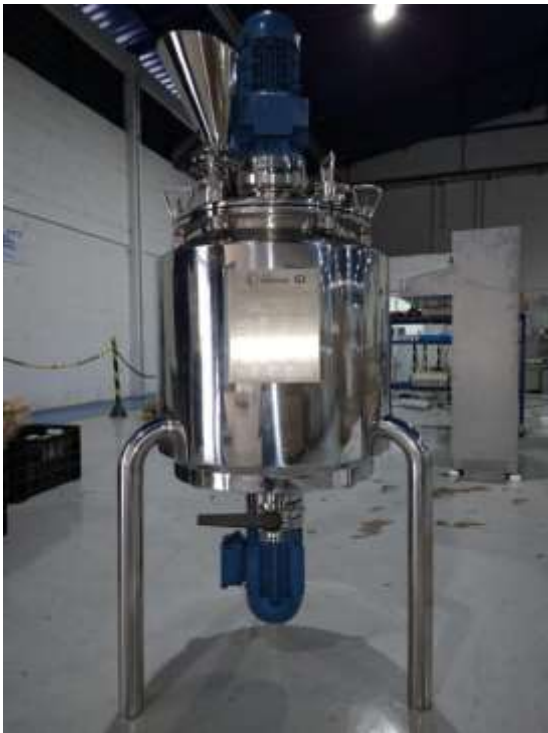
Figura 40 - Foto em Campo, Tanque IRR-CC-50 INOX 316
