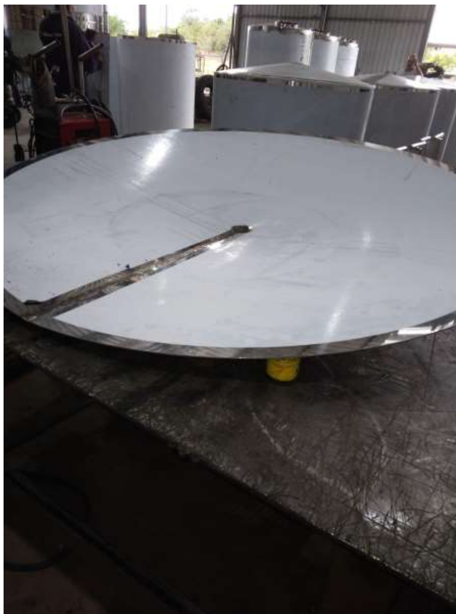
Figura 5 - Tampo Cônico utilizado no trabalho
