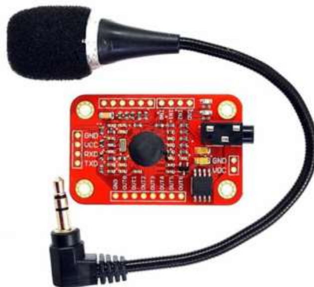
Figura 6. Módulo de Reconhecimento de Voz V3
