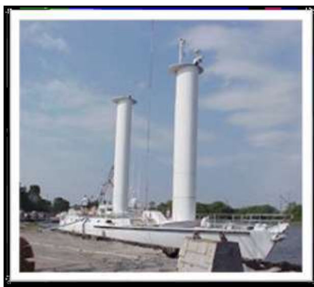
Figura 2.3 - Navio Calypso, embarcação que utiliza cilindros rotativos para propulsão. Para tirar vantagem do efeito Magnus, eles usam velas-rotor que são alimentados por um motor.
