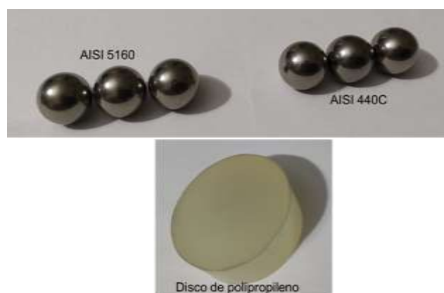
Figura 4. Corpos de prova: esferas de AISI5160, AISI 440C e disco de polipropileno.
