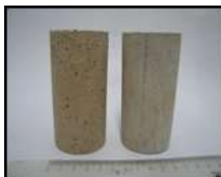
Figura 14 – Corpos de prova Ø 5x10 cm do 2º lote de argamassas
