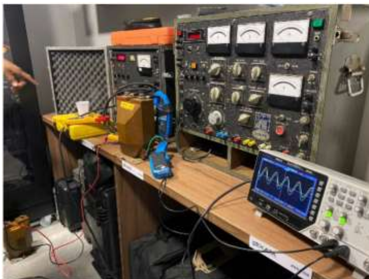
Figura 10. Bancada de ensaios para medição de erros de relação e ângulo.
