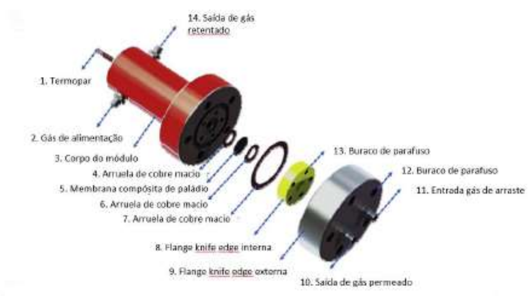
Figura 6-Diagrama esquemático do módulo de membrana.
