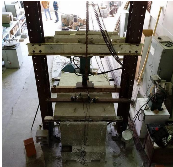
Figura 3 - Laje sobre apoio e colocação da placa de uniformização do carregamento sobre a laje.
