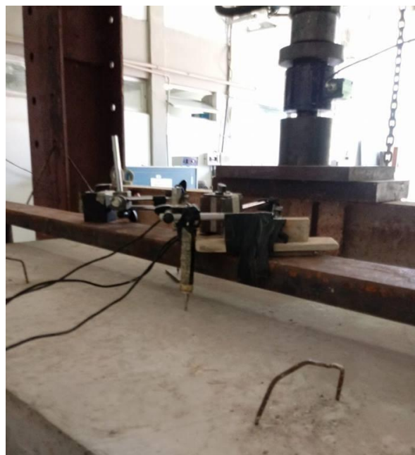
Figura 4 - Transdutores responsáveis pela leitura do deslocamento vertical.
