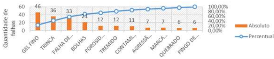
Figura 4 - Diagrama de pareto das falhas predominantes no convés da FK210. Fonte: Os autores (2018)
