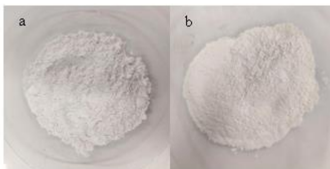
Figura 2. Dolomita antes (a) e depois da calcinação (b). (Autoria própria)
