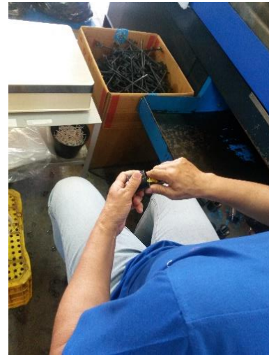
Figura 6 – Acabamento da peça: (a) corte dos galhos de injeção, (b) colocação dos galhos na caixa e (c) retirada das rebarbas da peça injetada
