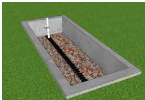
Figura 17 - Preenchimento com Entulho – Vista Diagonal
