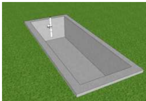
Figura 13 - Vista Diagonal da Posição do Cano PVC 100 mm com o "T"
