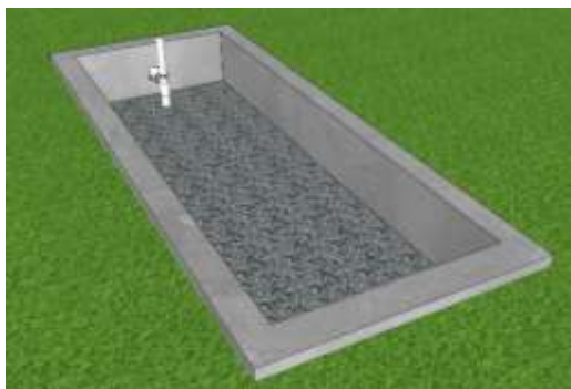
Figura 18 - Preenchimento com Brita
