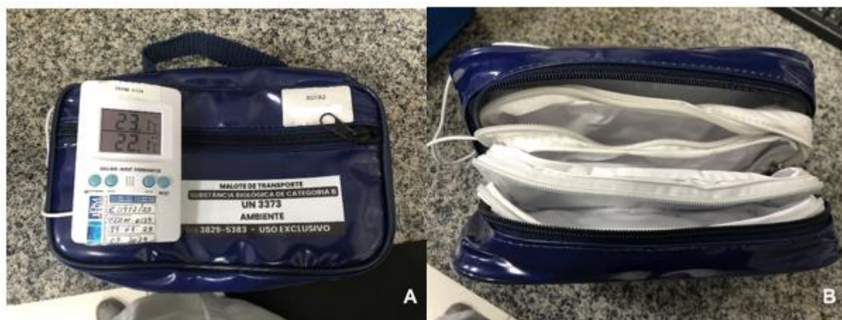
Figura 7: Representação de bolsa térmica para transporte de material biológico em temperatura ambiente. Podemos observar que dentro da bolsa não há nenhum tipo de gelo para refrigeração.
