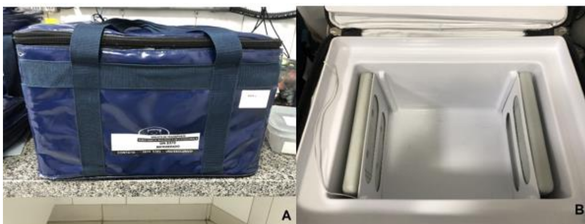
Figura 4: Representação de bolsa térmica para transporte de material biológico. Podemos visualizar uma bolsa com gelo reciclável, para realizar o transporte de material biológico em temperatura refrigerado.
