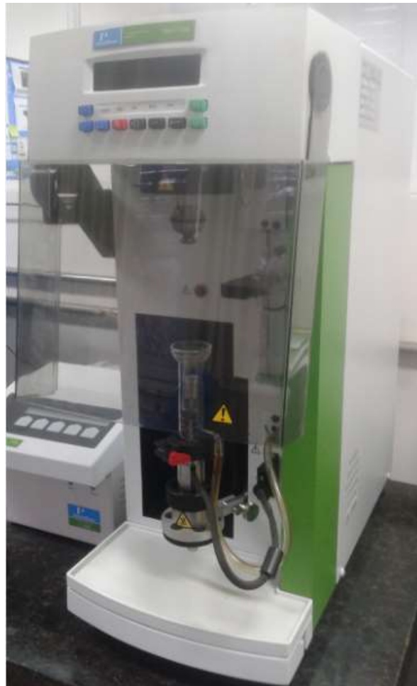
Figura 7. Equipamento para análises termogravimétricas.
