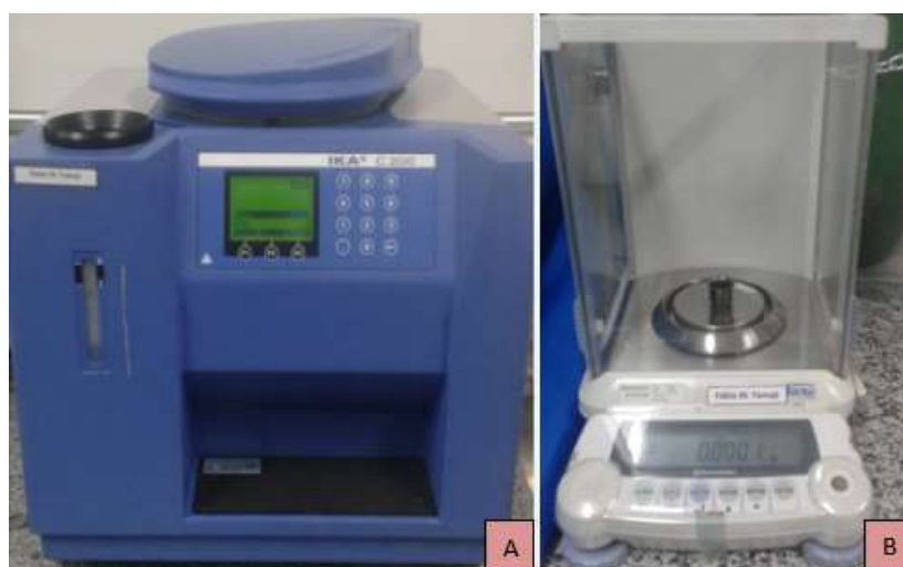
Figura 15. (A) Bomba calorimétrica; (B) Balança de precisão.
