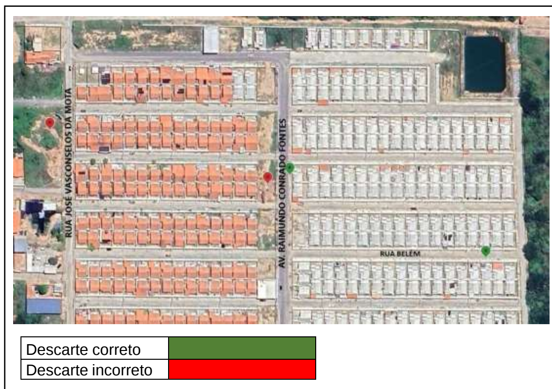
Figura 2 – pontos de descarte de resíduos da construção civil, bairro Alto do Sumaré, Mossoró-RN
