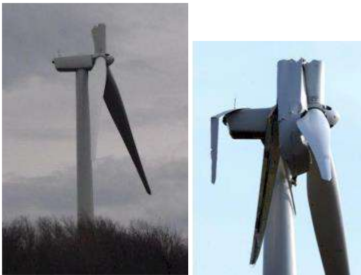
Figura 22. Falhas catastróficas das pás em turbinas GE.
