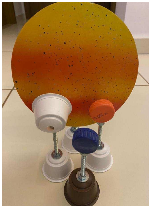
Figura 2 – Fotografia do conjunto construído com materiais de fácil acesso, em que se observa um anteparo de 20cm de diâmetro (alaranjado e amarelo), mecanismo de visada (branco) e dois anteparos de 2cm (Azul) e 3cm de diâmetro (alaranjado);
