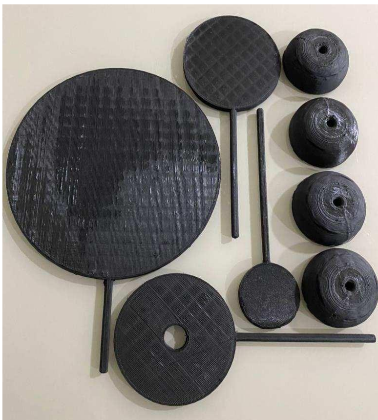
Figura 3 – Imagem fotográfica do resultado da impressão e verificação das dimensões dos objetos celestes impressos em impressora 3D (material PLA). Sendo: (1), (2) e (3) anteparos de diâmetros diferentes; (4) mecanismo de visada, e (5) as bases.
