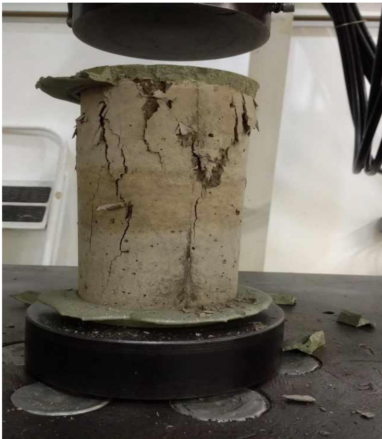
A2.21 - Rompimento do corpo de prova para verificação da resistencia máxima a compressão simples. Ultimo estagio do processamento do conglomerado ferruginoso laterítico e que foram levados a prensa hidráulica, conforme demonstra a foto.
