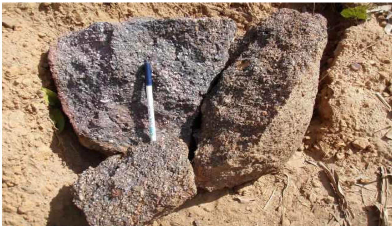
A2.3 - Detalhe da estrutura interna do conglomerado ferruginoso laterítico tendo a caneta como escala e assim dando ideia da proporcionalidade entre a matriz quartzosa, o cimento ferruginoso e a alteração diferencial a que foi acometida a rocha em face ao intemperismo físico químico diferencial.
