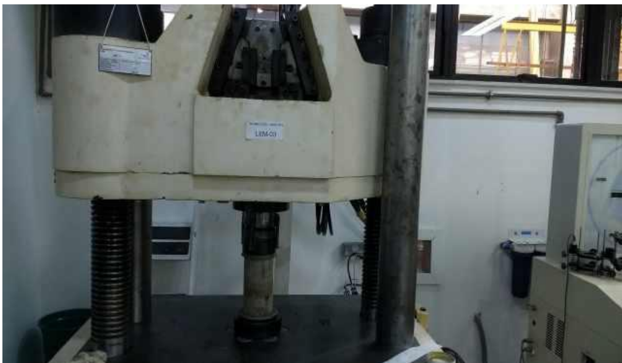
A2.18 - Prensa Hidráulica do NUMATS – COPPE – UFRJ, contendo um corpo de prova pronto para ser rompido e assim verificando a resistência a compressão axial simples de Mega-Pascal. Ensaio realizado com carregamento definido em 0,1 mm/ segundo.
