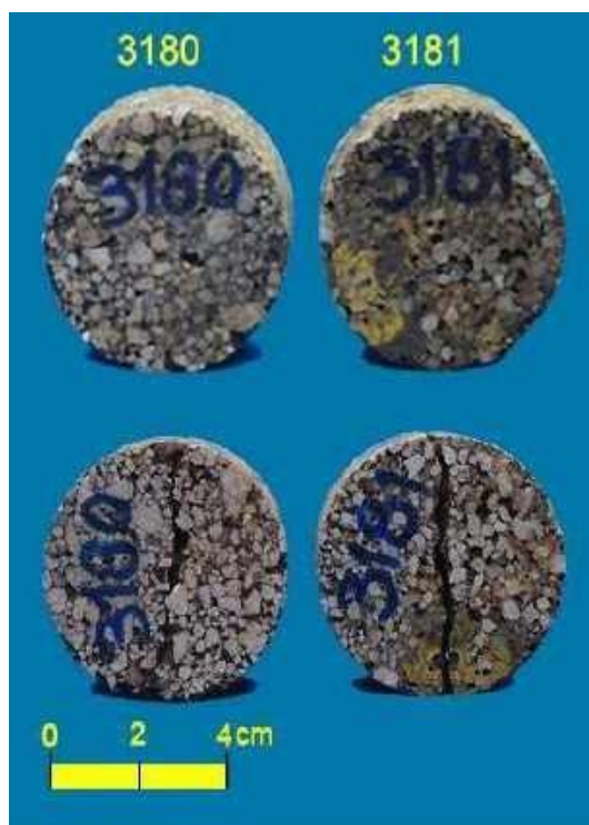
Figura 5.39 - Vista dos corpos de prova cp3180 e cp3181 antes e após ensaio de compressão puntiforme na direção axial. Bloco 01 AM 01 e litotipo conglomerado ferruginoso.
