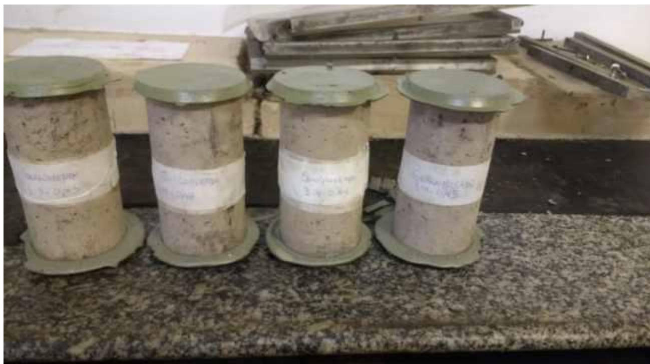
A2.19 - Corpos de prova de concreto com as superfícies regularizadas para posterior rompimento na prensa hidráulica. Os corpos de prova poderiam ser também regularizados cortando a superfície com serra diamantada. Uma massa específica de cimento com enxofre, dando assim uma plasticidade nos pontos terminais do corpo de prova.
