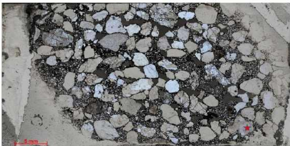
Figura 5.9 - Microfotografia com luz polarizada do conglomerado ferruginoso laterítico evidenciando a interação entre os óxidos cimentícios com a matriz quartzosa. Observar que o cimento ferruginoso engloba partículas muito finas de frações quartzosas com aspectos microscópicos obtidos através de lâmina petrográfica segundo luz polarizada.
