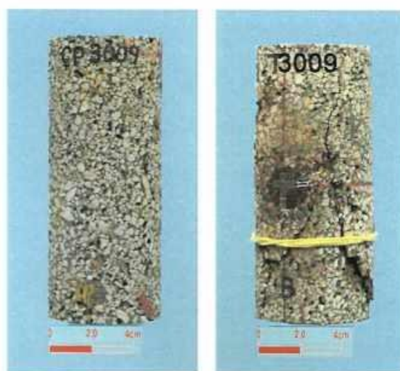
Figura 5.27 - CP 3009 antes e após o ensaio de compressão uniaxial.
