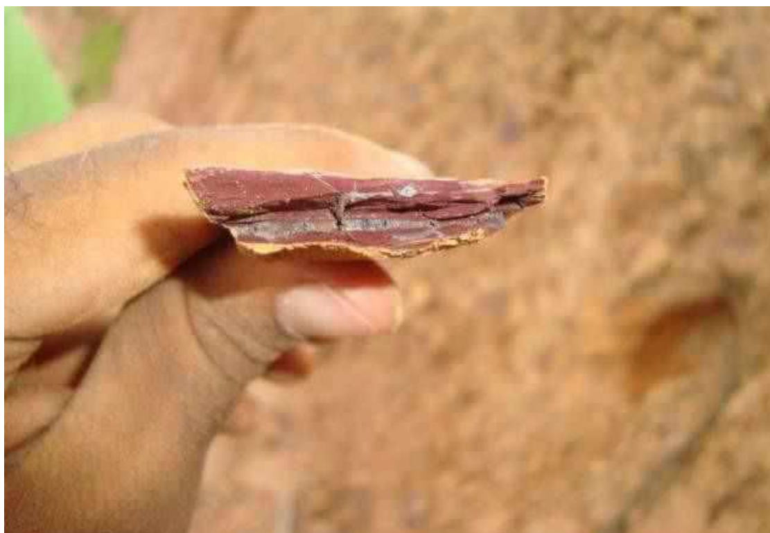
Figura A1.76 - Detalhe da amostra caracterizando uma estratificação do material e com quartzo.
