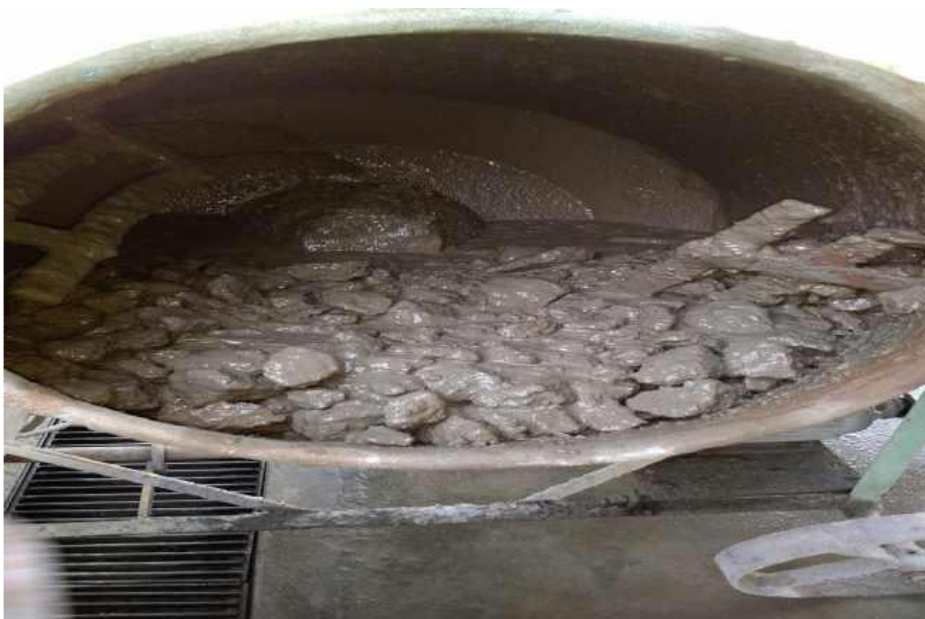
A2.9 - Massa de concreto homogeneizado com agregado, cimento e água nas devidas proporções para posterior moldagem nos corpos de prova e cura na câmara húmida, após que serão rompidas na prensa hidráulica para verificação da resistência a compressão simples em MegaPascal.
