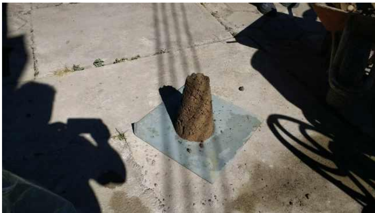
A2.13 - Concreto desformatado da forma de Slump Teste. Notar que o concreto permaneceu com o mesmo formato da forma, significando que o resultado do Slump é praticamente nulo e assim a trabalhabilidade deste concreto é insuficiente. Neste caso fator água cimento deverá ser aumentado.
