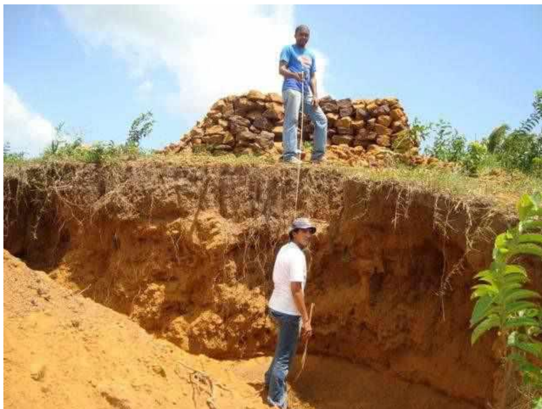
Figura A1.23 - Carrada de lateritas prontas para o despacho.
