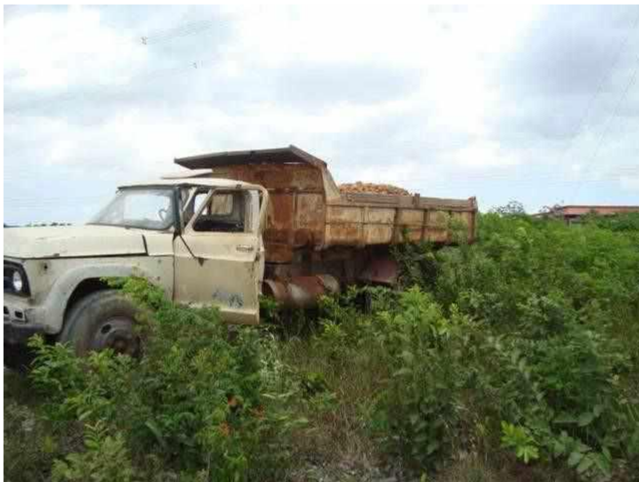
Figura A1.21 - Caminhão basculante, capacidade de 6m 3 utilizado no transporte de lateritas.
