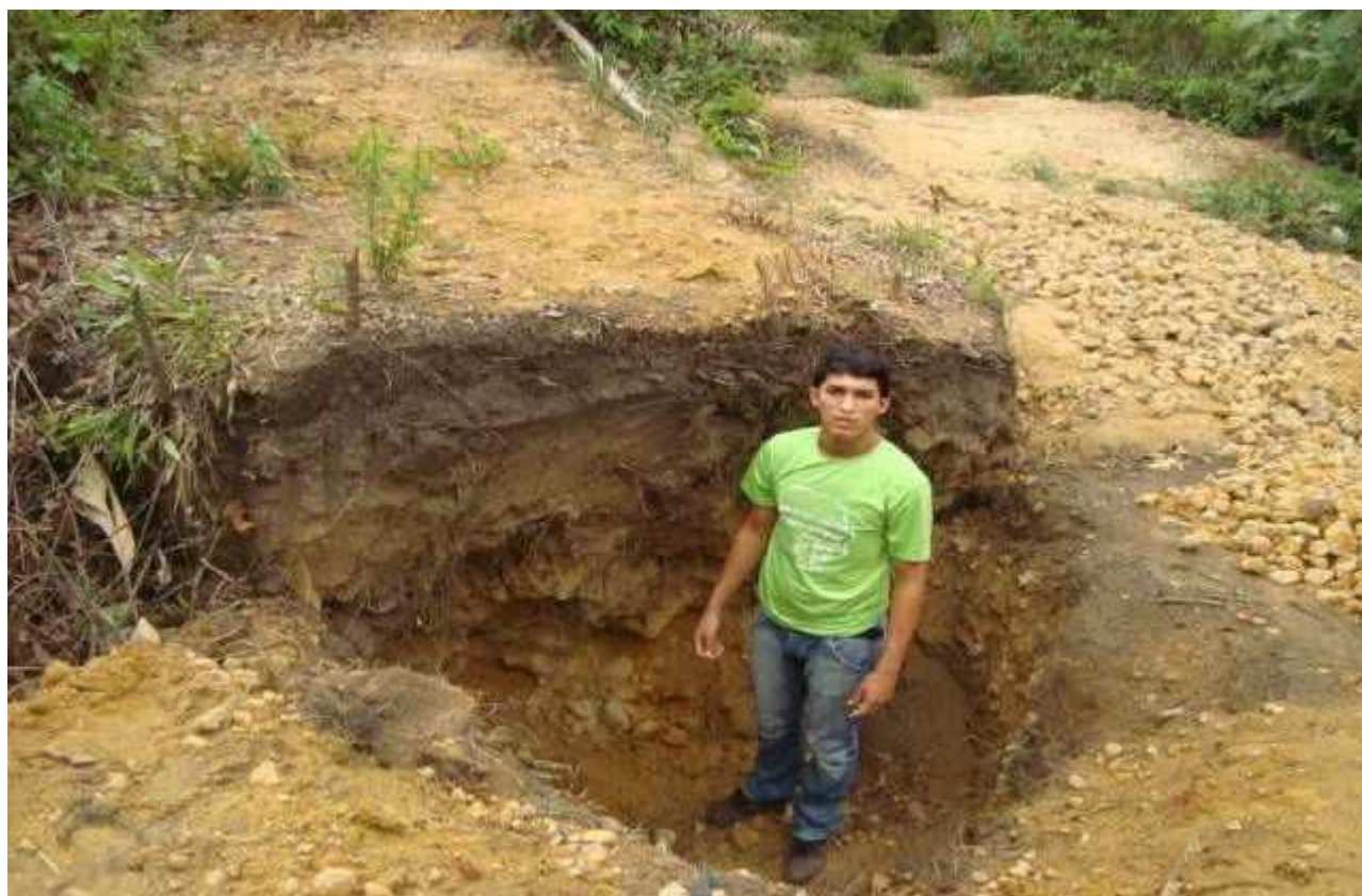
Figura A1.74 - Cava da extração da laterita expondo o stone line.
