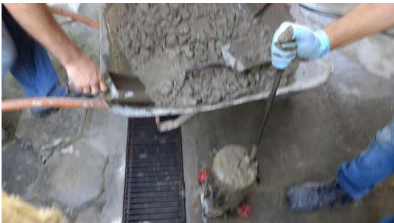
A2.11 - Corpos de prova de concreto sendo compactados com bastão de compactação em camadas com respectivos golpes, segundo as normas.
