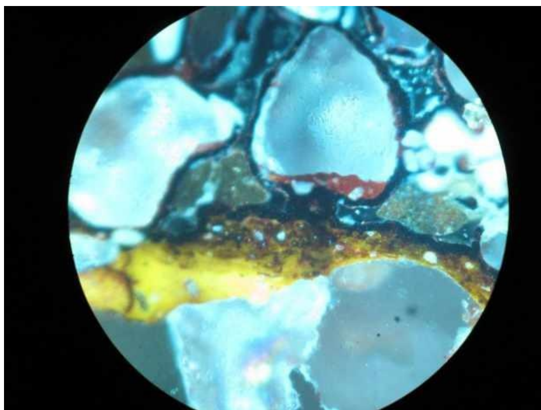
Figura 5.16 – Microfotografia com a luz refletida do conglomerado ferruginoso laterítico denotando a gohetita representada pela cor amarela, a hematita representada pela cor marron e o quartzo representado pela cor branca.
