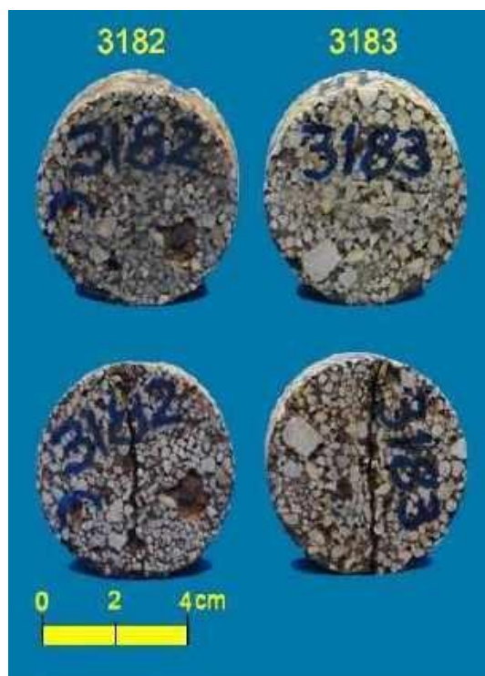
Figura 5.40 - Vista dos corpos de prova cp3182 e cp3183 antes e após ensaio de compressão puntiforme na direção axial. Bloco 01 AM 01 e litotipo conglomerado ferruginoso.
