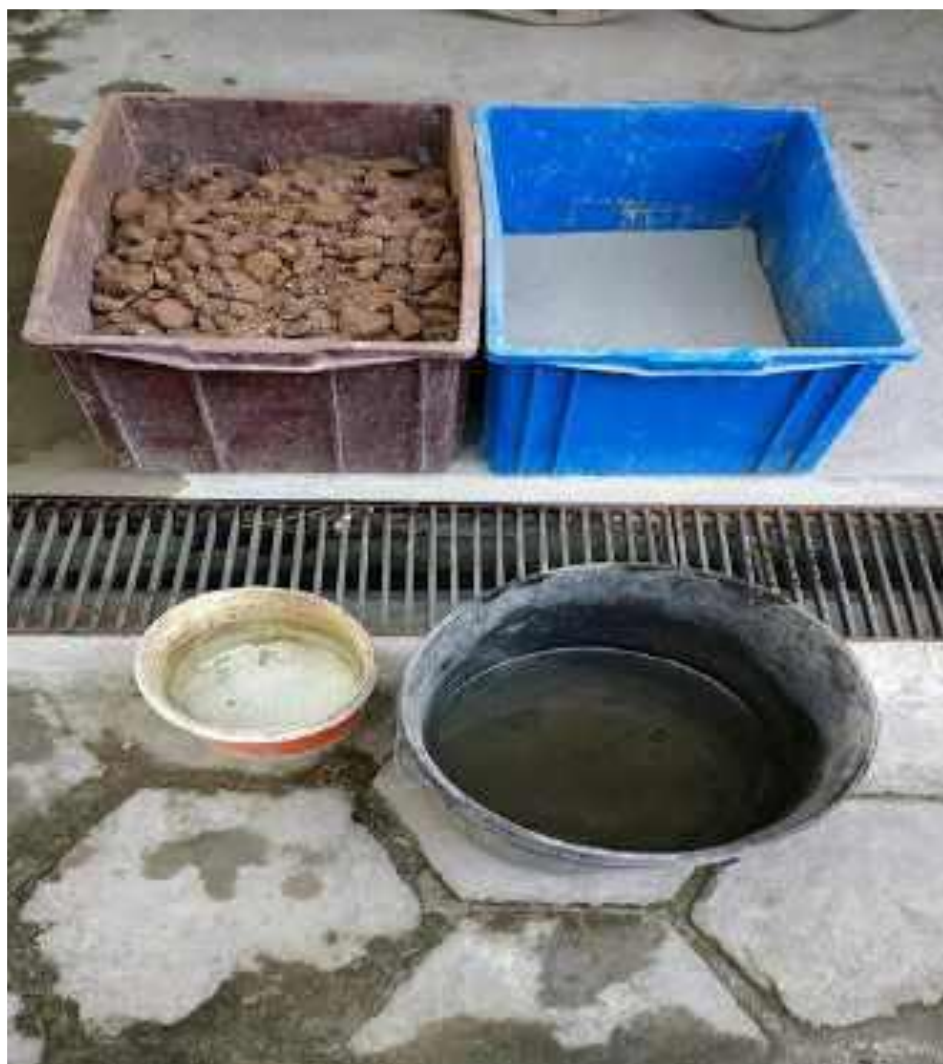
A2.7 - Os materiais, agregado, cimento Portland e água são separados para posterior mistura nas devidas proporções.
