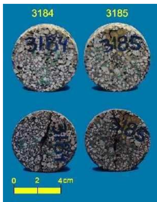
Figura 5.41 - Vista dos corpos de prova cp3184 e cp3185 antes e após ensaio de compressão puntiforme na direção axial. Bloco 01 AM 02 e litotipo conglomerado ferruginoso.
