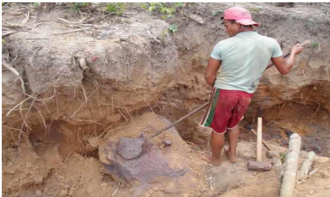
A2.2 - Partição do bloco grande em blocos pequenos utilizando marreta, punção grande e alavanca.
