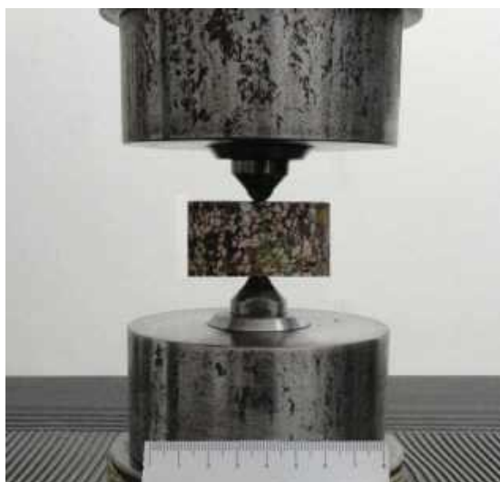
Figura 5.38 - Corpo de prova ajustado entre os pratos da máquina universal de ensaios para realização de ensaio de compressão puntiforme na direção axial.
