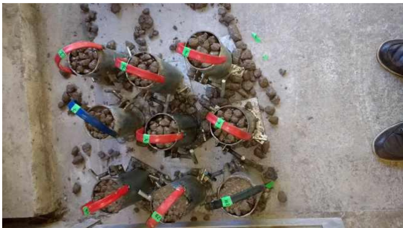
A2.16 - Um detalhe da foto anterior em que evidencia a falta de agregado fino (areia fina média e grossa) entre os agregados graúdos. Estes vazios sem o devido preenchimento promovem uma diminuição da resistência do concreto que foi moldado no corpo de prova.
