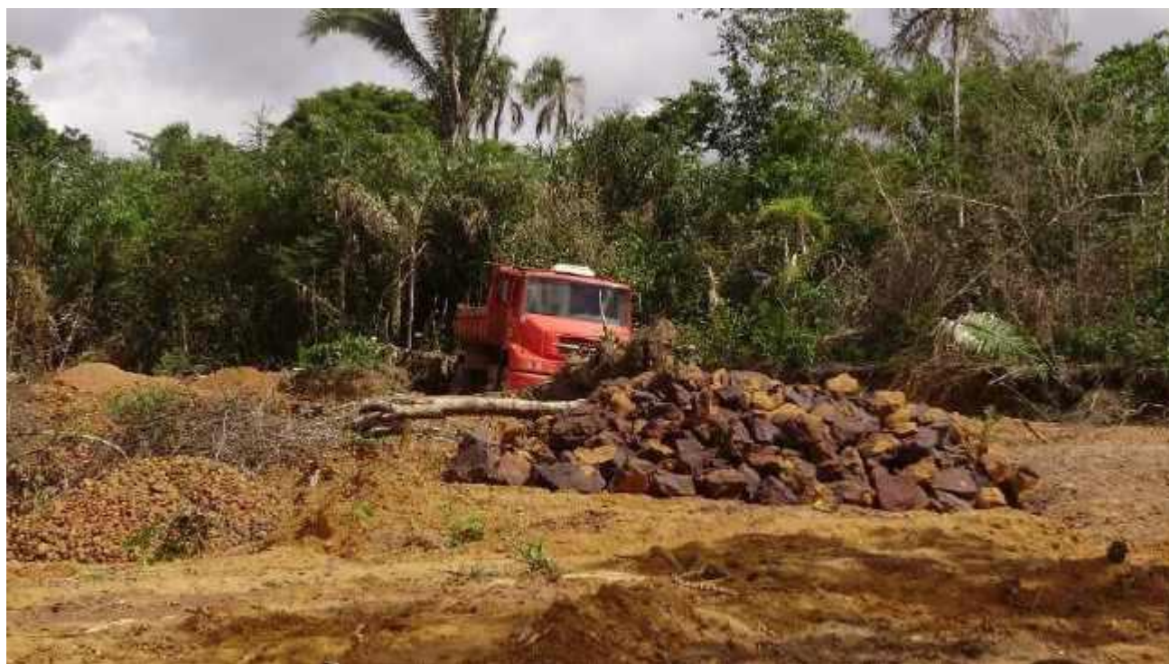
Figura A1.58 - Blocos de conglomerado ferruginoso extraídos aguardando carregamento.
