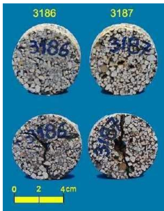
Figura 5.42 - Vista dos corpos de prova cp3186 e cp3187 antes e após ensaio de compressão puntiforme na direção axial. Bloco 02 AM 01 e litotipo conglomerado ferruginoso.
