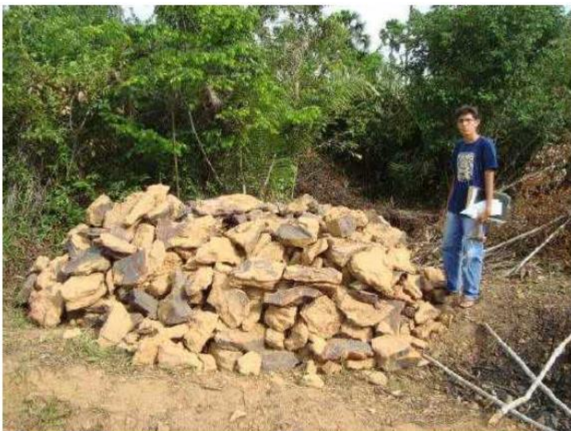
Figura A1.8 – Carrada (volume carregado no caminhão) pronta para o carregamento.
