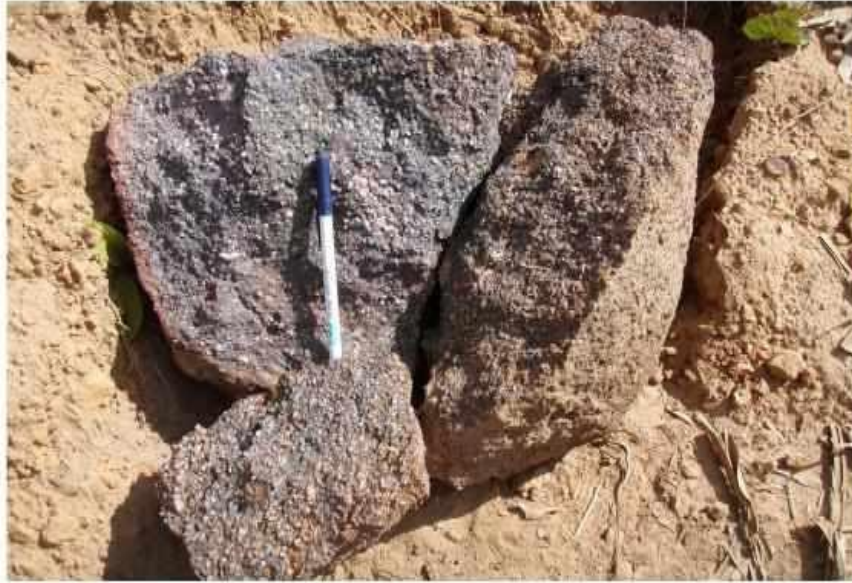
Figura 5.8 - Detalhe da estrutura interna do conglomerado ferruginoso laterítico da jazida do Maracujá, tendo a caneta azul e branca como escala e assim dando ideia da proporcionalidade entre a matriz quartzosa, o cimento ferruginoso e a alteração diferencial a que foi acometida a rocha face ao intemperismo físico-químico diferencial.
