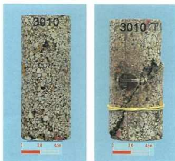
Figura 5.28 - CP 3010 antes e após o ensaio de compressão uniaxial.
