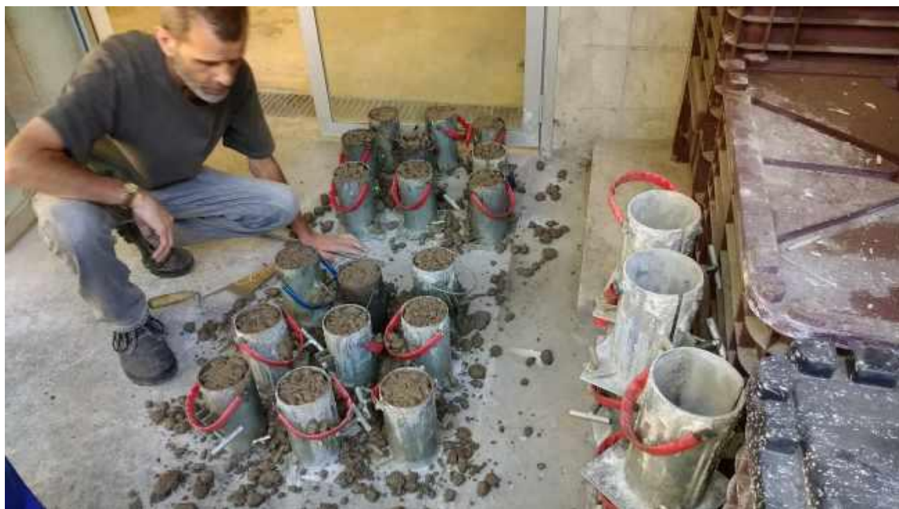
A2.15 - Um grupo de corpos de prova de concreto que foram moldados, que após 24 horas serão desmoldados e levados para a câmara húmida.
