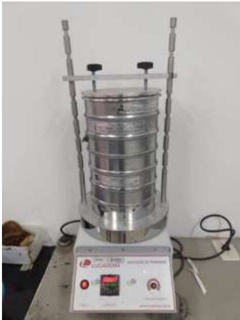
Figura 5 - Peneiramento da areia para caracterização
