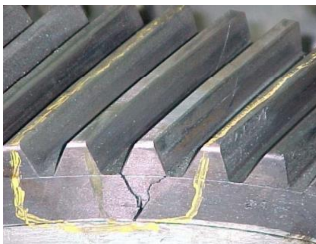
Figura 5 – Falha por flexão no pé do dente da engrenagem.
