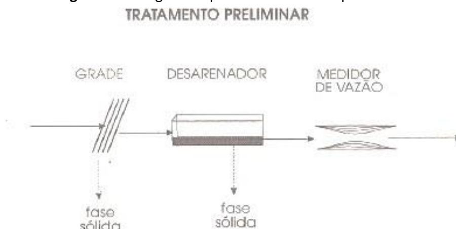
Figura 4. Fluxograma típico do tratamento preliminar
