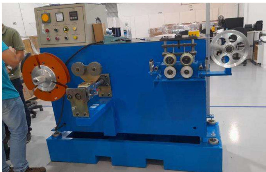
Figura 7 – Máquina de medição de cabos ergonomicamente adaptada
