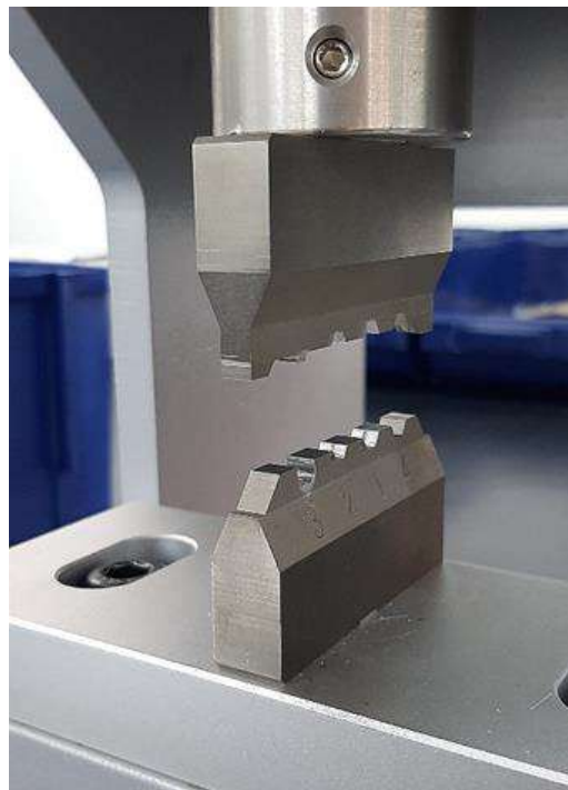
Figura 3 – Detalhe da crimpadora sem segurança
