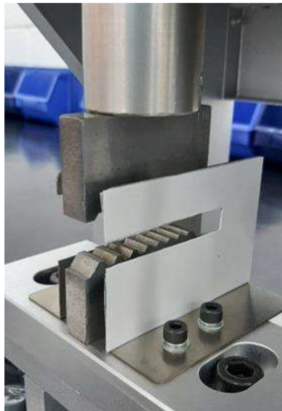
Figura 6 – Dispositivo de segurança instalado na máquina crimpadora.
