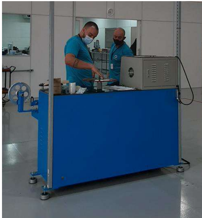
Figura 6 – Máquina de medição de cabos
