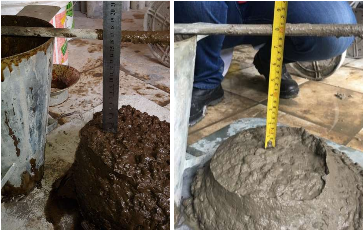
Figura 2 - Slump Test para o CRM e CR
