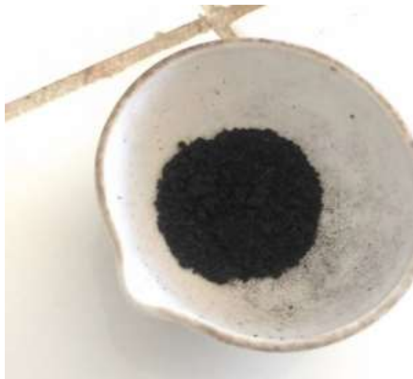
Figura 2: Carbono ativado obtido a partir de ativação química e física.
