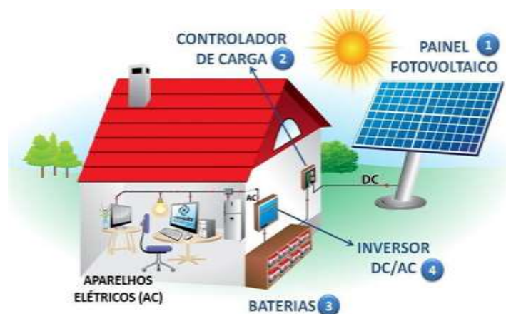
Figura 4 – Componentes de sistemas de energia elétrica fotovoltaica
