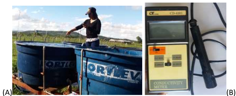
Figura 09. Verificação da condutividade elétrica da água (A), condutivímetro usado na verificação (B)
