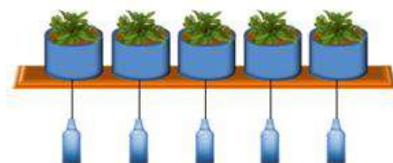
Figura 9 - Vista lateral demonstrativa dos lisímetros de drenagem localizados em ambiente protegido.
