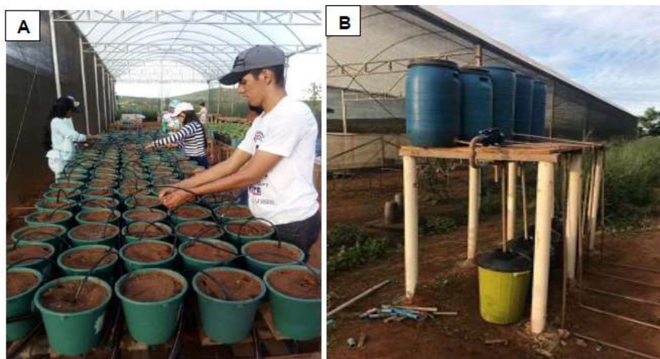
Figura 7 - Aferição da vazão dos gotejadores em ambiente protegido.
