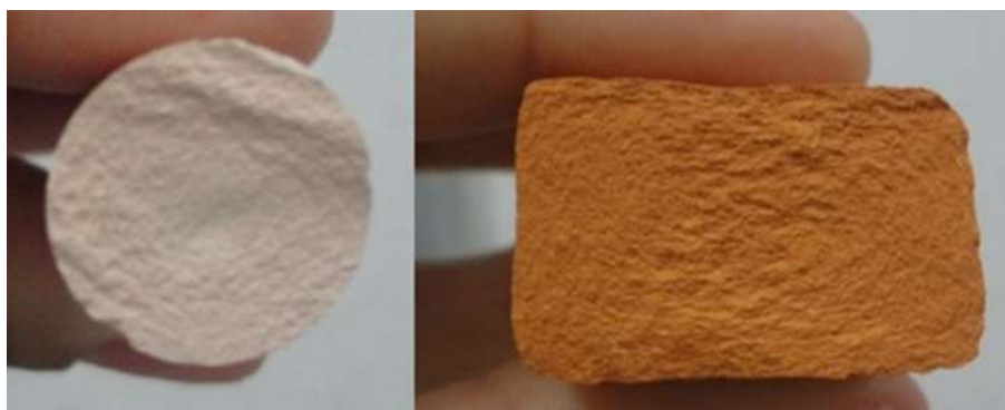
Figura 4 – Seções transversais dos corpos de prova no local da ruptura
