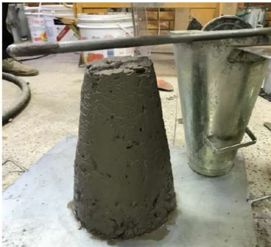
Figura 2 – Teste de abatimento do tronco de cone
