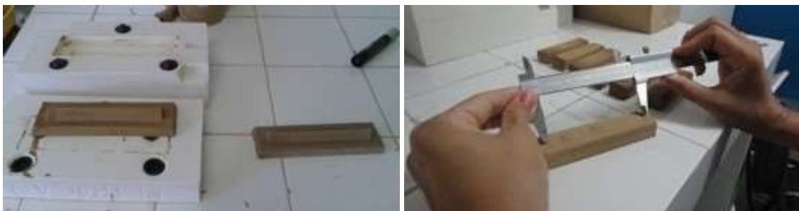
Figura. 1 – Produção dos Corpos de prova usado nos ensaios de retração, perda ao fogo e absorção.
