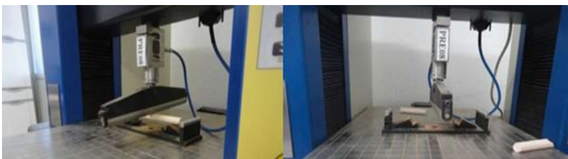
Figura 3. Ensaio de Flexão em corpo de prova de secção cilíndrica
