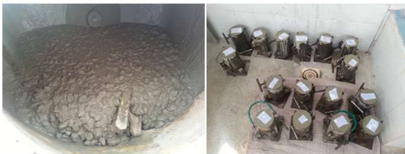
Figura 2 – Mistura final obtida (à esquerda) e 16 corpos de prova (8 para cada traço) moldados (à direita)
