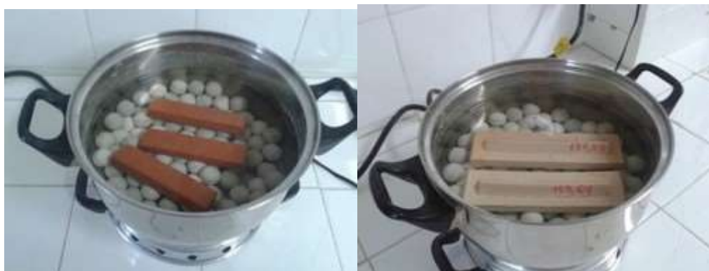
Figura 5 – Ensaio de absorção de água em ambos os corpos de prova
