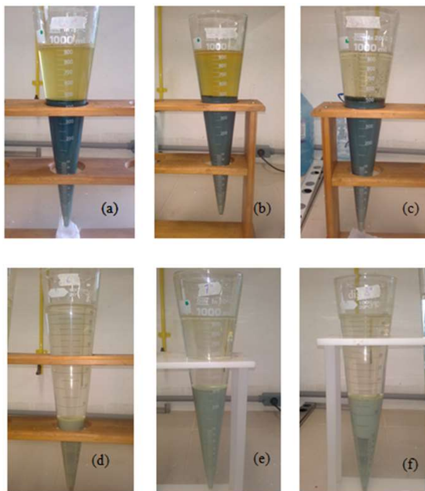
Figura 1: Foto das amostras de efluente (mistura) em cone Imhoff após tratamento por precipitação com cal hidratada (a) pH 7, (b) pH 8, (c) pH 9; e com soda barrilha (d) pH 7, (e) pH 8 e (f) pH 9.
