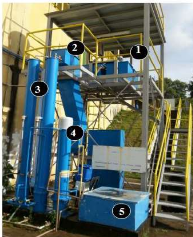
Figura 2: Foto da Instalação Piloto – 1.Floculadores, 2.Decantador, 3.Filtros Rápidos, 4.Coluna de CAG e 5.Tanque de Contato.
