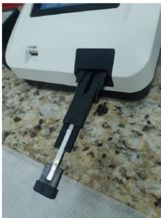
Figura 6 – Fita-teste sendo encaixada no equipamento de leitura
