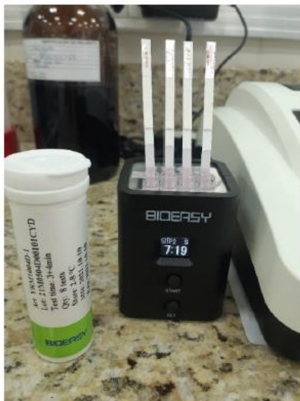
Figura 5 – Fitas-teste adicionadas nos microwells
