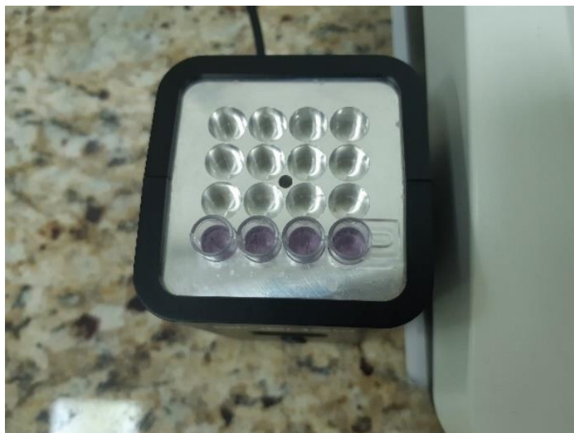
Figura 1 – Microwells com reagente na incubadora
