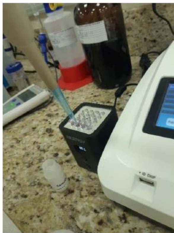
Figura 2 – Adição do diluente nos microwells
