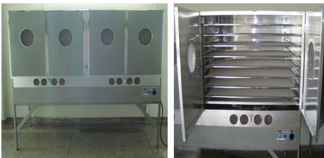
Figura 4. Vistas a) do desidratador b) das bandejas dispostas no desidratador.
