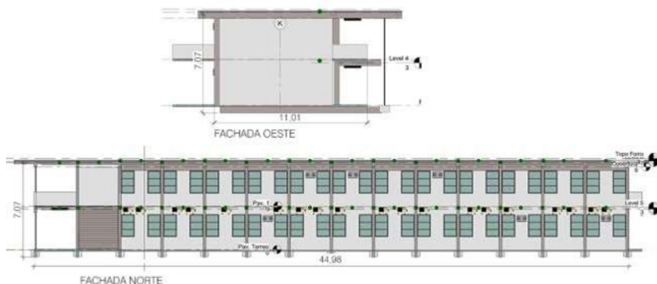
Figura 4.11 - Cotas totais nas fachadas Norte e Oeste.
