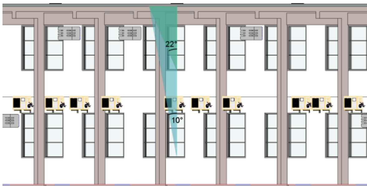
Figura 4.15 - Ângulos de sombreamento vertical da fachada norte.
