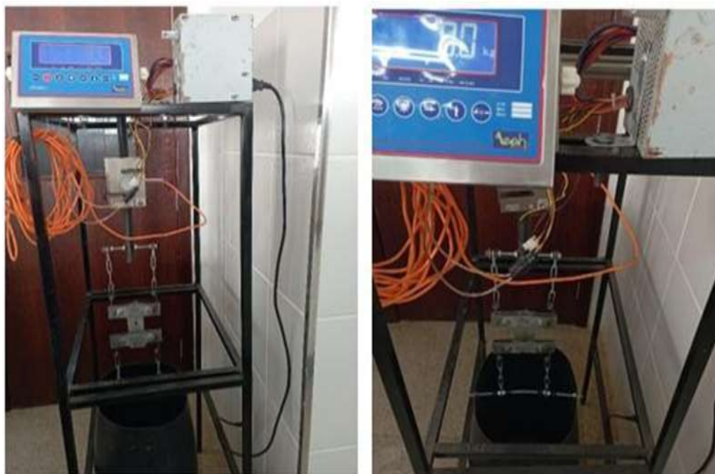
Figura 4 - Equipamento de aferição de cargas.
