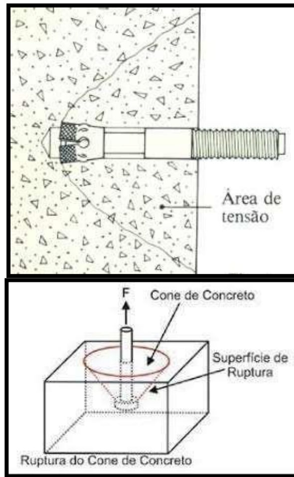
Figura 4: Formação do cone de concreto
