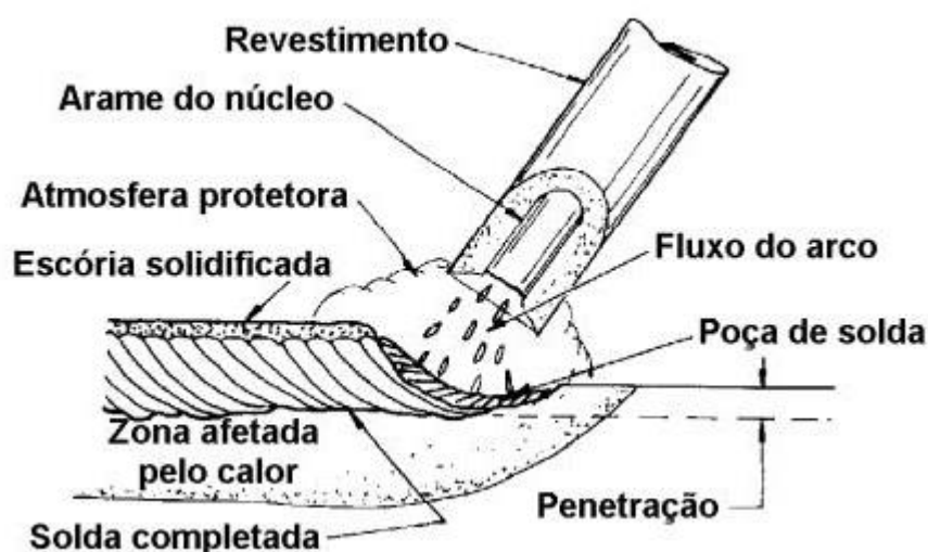
Figura 12– Solda com Eletrodo Revestido
