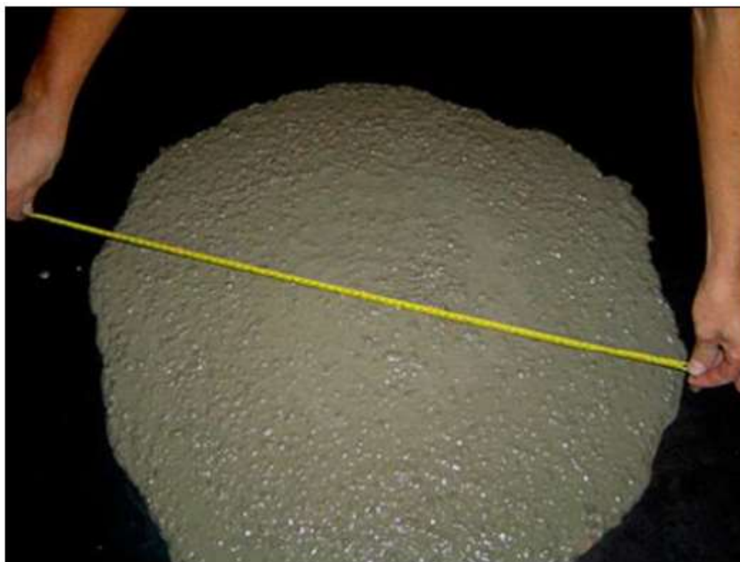
Figura 4 - Ensaio de Espalhamento (Slump Flow Test)
