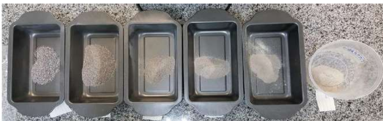
Figura 3 - Ensaio de granulometria dos pós das cascas de sururu.
