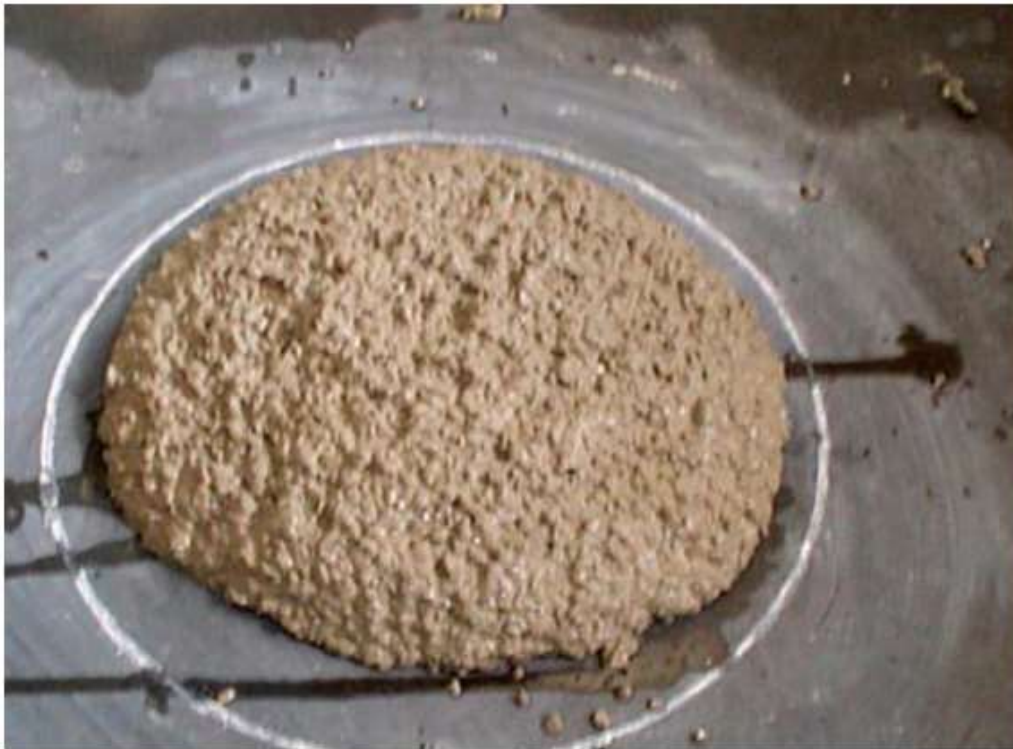
Figura 5 - Ensaios de slump flow test com o slumpflow T 30cm test
