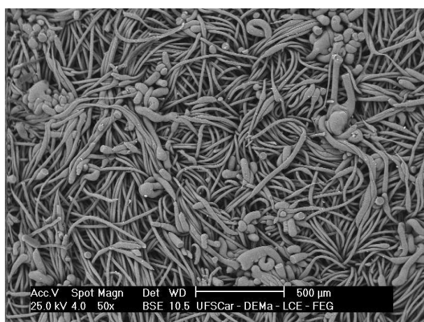
Figura 3 – Imagem obtida em MEV da superfície do filtro PAN (Magnificação de 50x).
