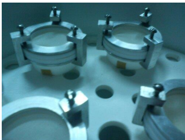
Figura 2 – Células de teflon e alumínio utilizadas na análise de permeabilidade ao vapor de água.
