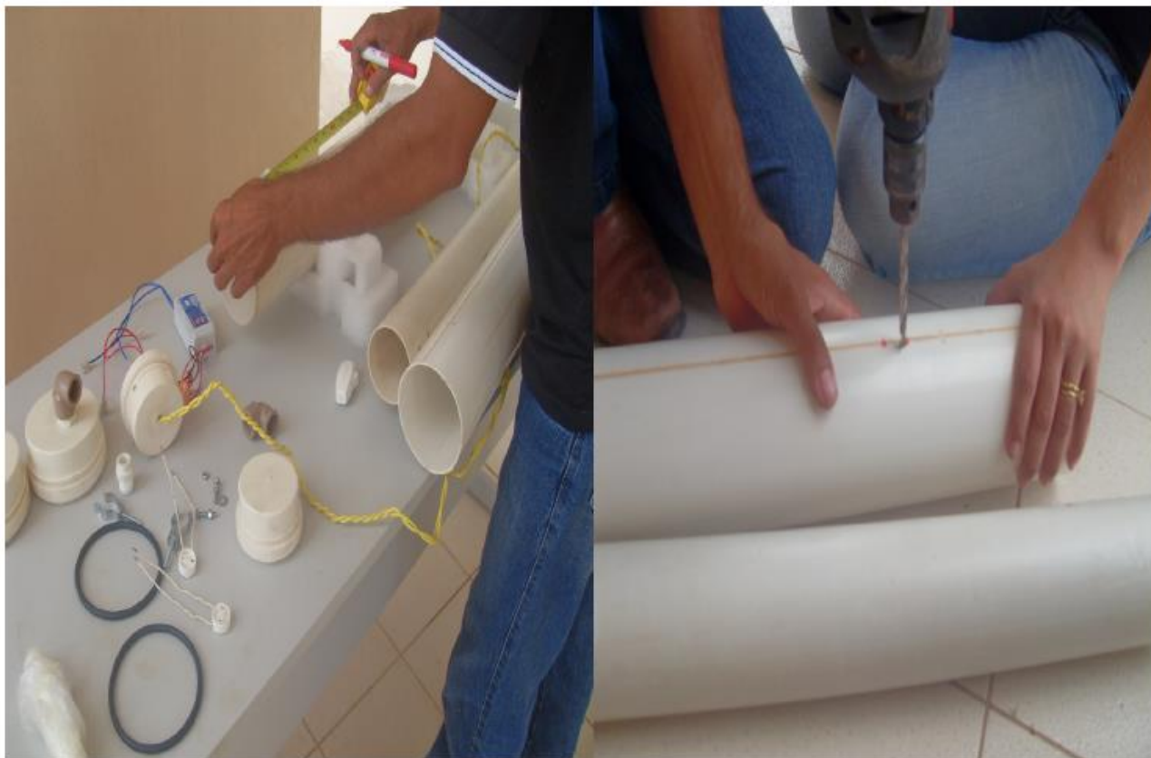
Figura 09 - Imagens de discente integrante da equipe de pesquisa, nas instalações do Câmpus Zé Doca, construindo e adaptando 05 (cinco) Tubos UVs, em maio de 2011- Zé Doca, Maranhão, Brasil.
