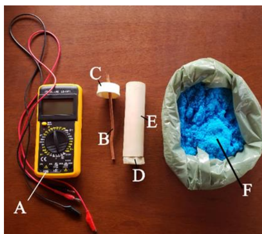
Figura 10 -Eletrodo de referência cobre/sulfato de cobre elaborado por Figueiredo E.J.P.
