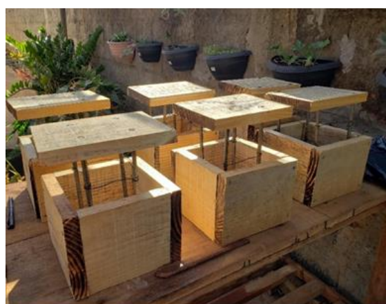
Figura 8 -Moldes prontos para concretagem
