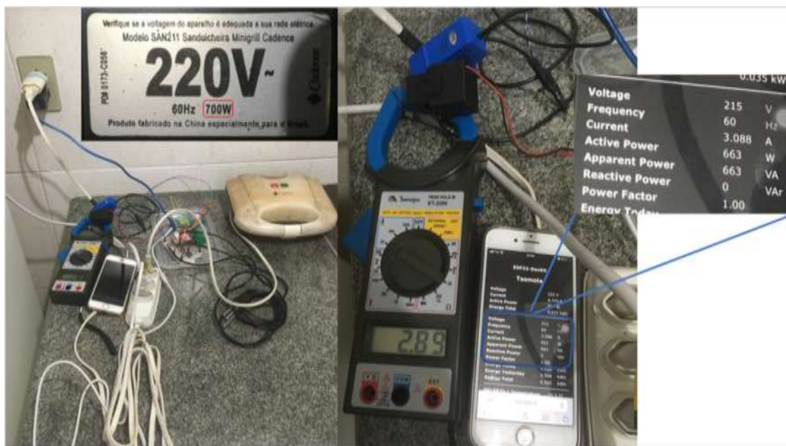
Figura 5 - Medição de corrente PZEM-004T VS Alicate amperímetro - Sanduicheria 700W em 21/06/2022. (a) À esquerda, visão geral do teste realizado; (b) à direita, foto ampliada para visualização da corrente registrada pelo alicate amperímetro e pelo sistema via interface web. Fonte: Elaborada pelo autor.
