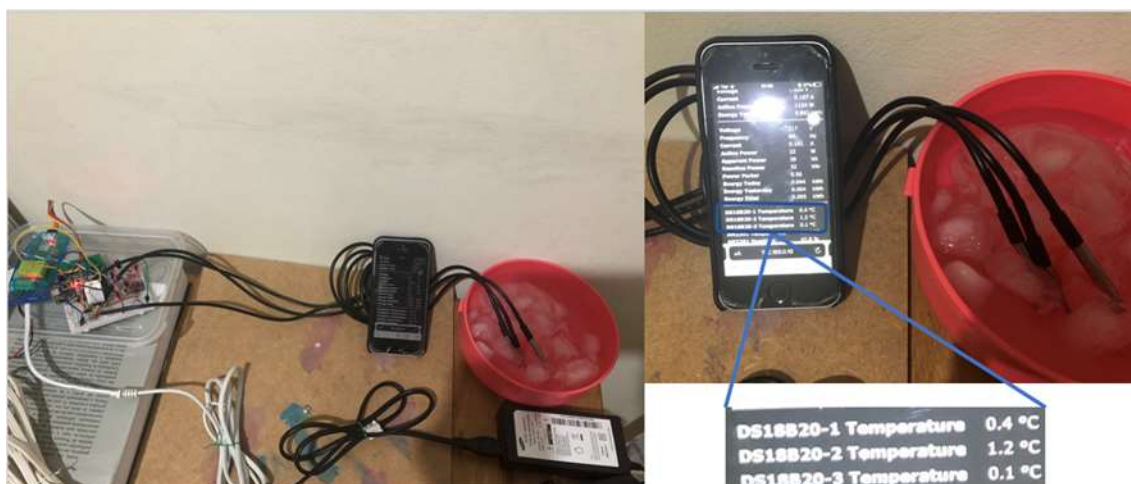
Figura 10 - Teste 6.b: Temperatura de referência 0°C (gelo). (a) À esquerda, visão global do experimento; (b) à direita, foto ampliada para visualização do registro das temperaturas próximas a 0°C na interface gráfica do Tasmota. Fonte: Elaborada pelo autor.
