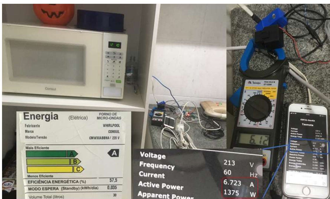
Figura 6 - Medição de corrente PZEM-004T VS Alicate amperímetro – Micro-ondas 1400W em 21/06/2022. Fonte: Elaborada pelo autor
