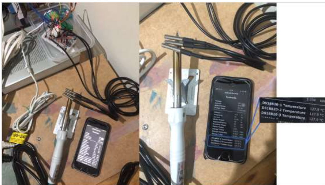
Figura 1 - Teste 6.a: Aquecimento até ultrapassar temperatura de saturação dos sensores. (a) À esquerda, visão geral do experimento; (b) à direita, foto ampliada para visualização dos valores registrados pelos sensores (127,9°C) na interface gráfica do Tasmota. Fonte: Elaborada pelo autor.
