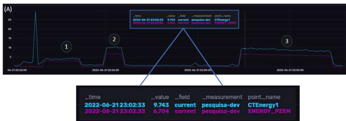
Figura 7 - Medições de corrente PZEM-004T vs SCT-013 no dia 21/06/22. Fonte: Adaptada da interface gráfica do InfluxDB
