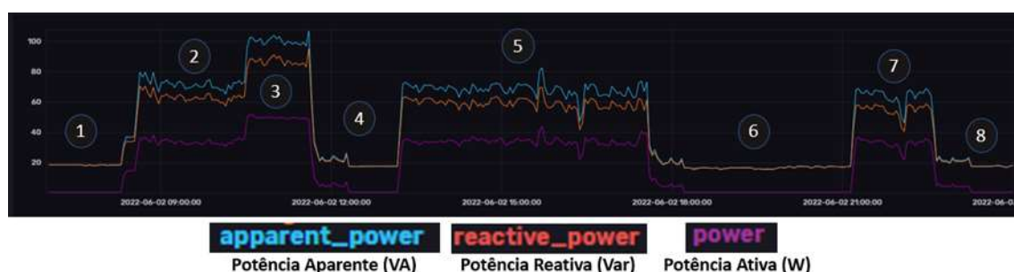
Figura 4 - Monitoramento das grandezas elétricas no dia 02/06/2022. Fonte: Adaptada da interface gráfica do InfluxDB.
