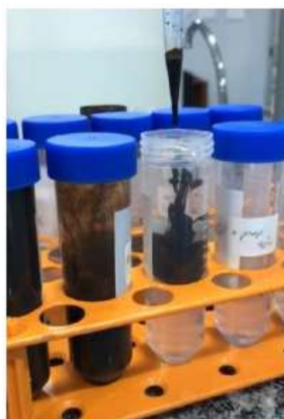
Figura 4 – Etapa de obtenção de NF à base de NPF dispersas em água propilenoglicol.
