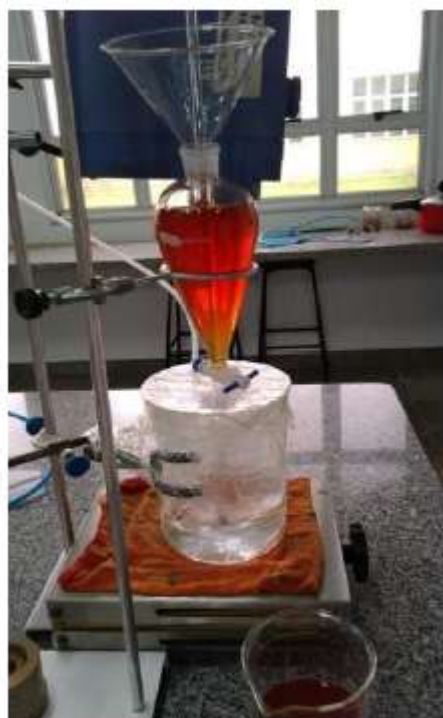
Figura 3 – Etapa de síntese por co-precipitação das NPs de óxido de ferro.
