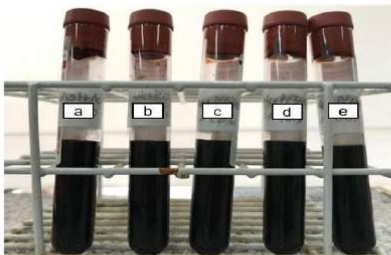
Figura 19 - NF3 classificados em teor de propilenoglicol: a) 0%; b) 25%; c) 50%; d) 75%; e) 100%.
