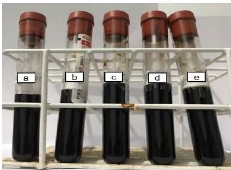
Figura 21 - NF2 classificados em teor de propilenoglicol a) 0%; b) 25%; c) 50%; d) 75%; e) 100%.
