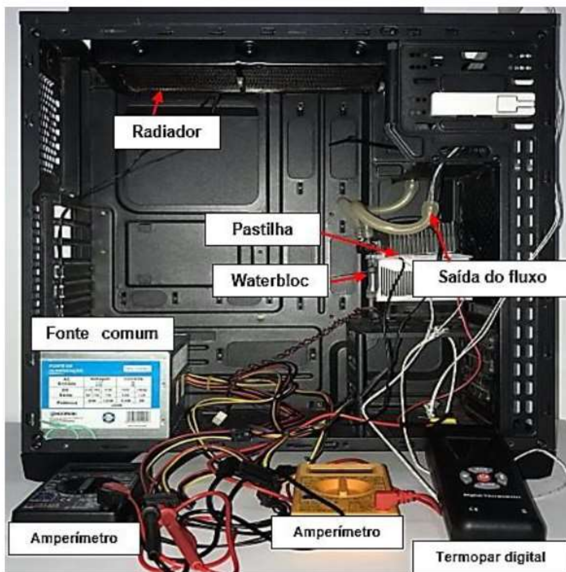
Figura 26 - Protótipo de sistema de troca de calor desenvolvido (a) versão 1, e (b) versão 2.
