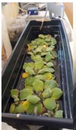
Figura 2. Wetland em escala de bancada com a macrófita flutuante Pistia sp.
