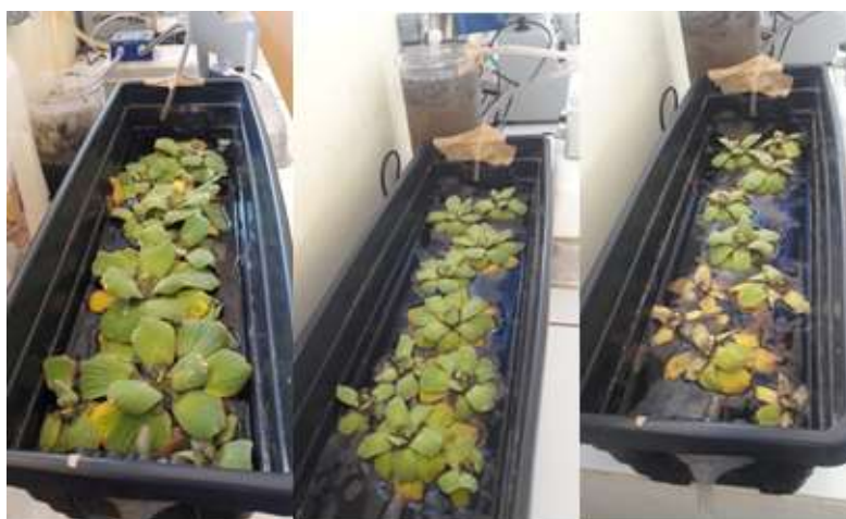
Figura 7. Aspecto visual da planta ao longo do tempo (0, 8 e 12 dias), no processo wetland com a macrófita Pistia Sp e o efluente de Parboilização de arroz.
