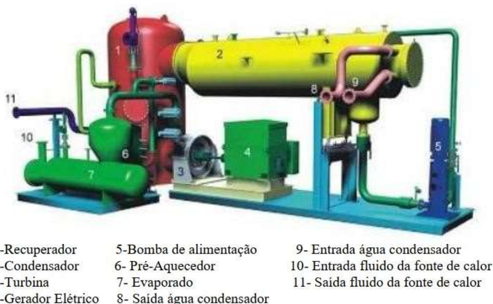
Figura 7 – Ciclo Rankine orgânico com recuperador e pré-aquecedor.
