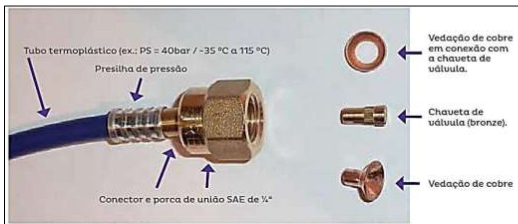
Figura 6.4 - Montagem recomendada para para conectores.
