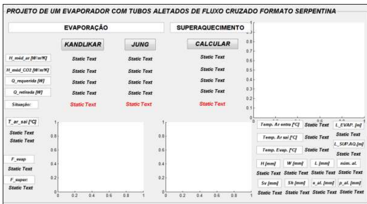
Figura 4.6 - Interface gráfica do programa criado em MATLAB para projeto do evaporador
