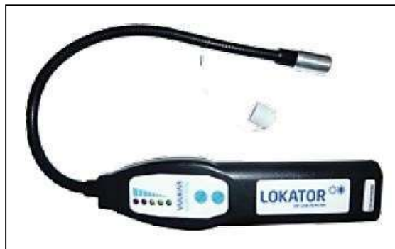
Figura 6.3 - Detector de gás para teste de vazamento.
