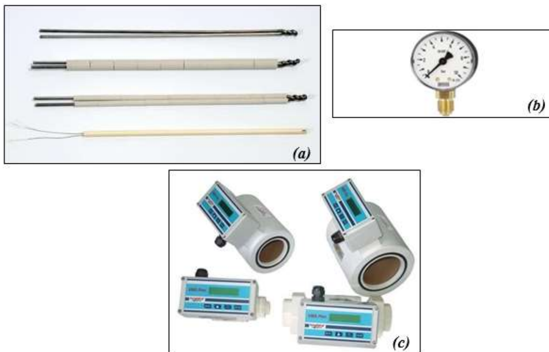
Figura 3.14 - Instrumentos de medição: termopares tipo K (a); manômetro bourdon (b) e medidor de vazão Incontrol VMS PRO (c)
