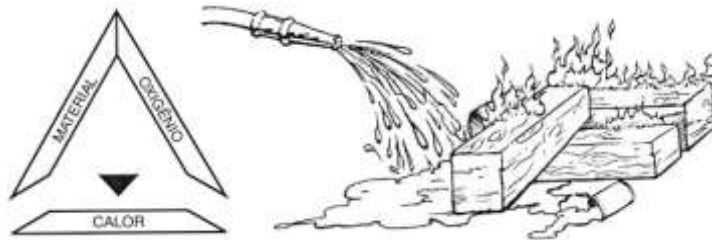
Figura 11 – Extinção por retirada de calor.
