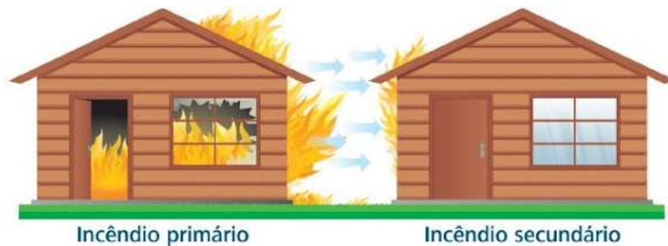
Figura 7 – Condução de calor por radiação térmica.
